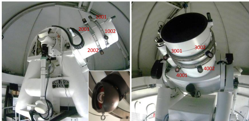
Abb. 3: SOS-W mit vier seitlich montierten und ausgerichteten CER (links) der Konfiguration I und vier frontal installierten CER (rechts) der Konfiguration II. Das Detailbild zeigt einen der verwendeten CER, die einen Öffnungswinkel von \pm 60^\circ aufweisen und magnetisch am Teleskop befestigt wurden.
