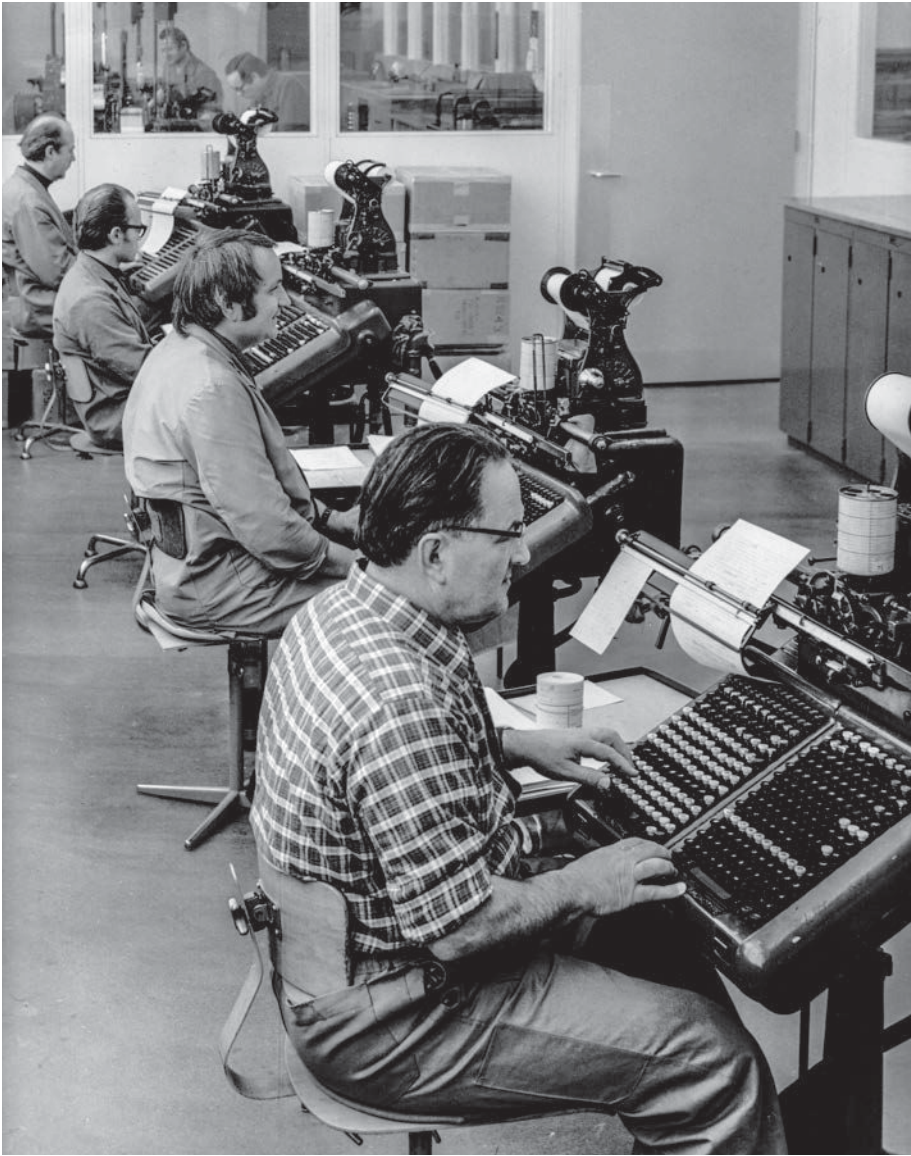
22 Setzer an Monotype-Taster im neuen Fabrikationsgebäude, Fotografie von Franz Kälin, nach 1970.
