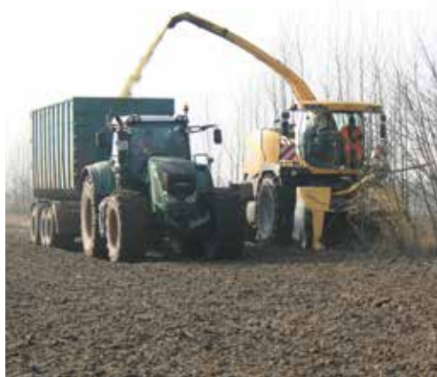
Colheita mecânica das sebes arbóreas num sistema de culturas entrelinhas. Ref: Kanzler, 2015
