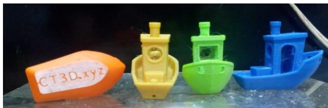
Fig. 1. Exemplo de objeto para verificação da calibração das impressoras (amostras de impressão 3D)
