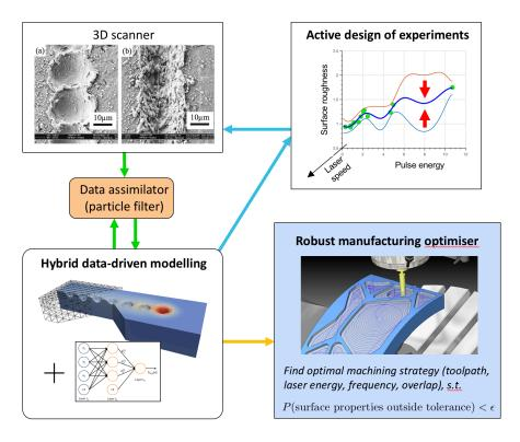
Figure 6.1: Jumeau numérique pour l'usinage laser de précision
