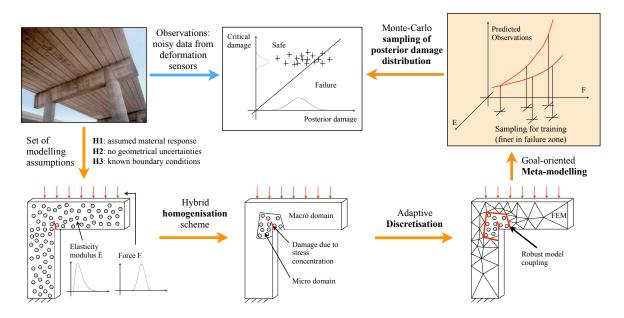
Figure 1.2: Principe du jumelage numérique (inexistant à l'heure actuelle). Une modèle numérique fin de la structure est recalé en temps réel, et peut être résolu pour prédire l'issu de différents cas de charge ou cycles d'utilisation.
