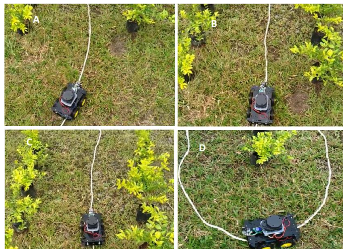
Figura 16. Navegación del robot con la Pixy2, (A) Ingresando al cultivo, (B) Dentro del cultivo, (C) Saliendo del cultivo, (D) Girando a la siguiente parcela
