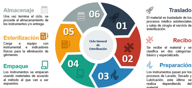
Figura 4. Ciclo general de esterilización de instrumental
