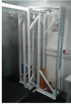
Figura 16. Sistema de contrapesos en parte posterior de HYNMERS (tubos para cadenas)
