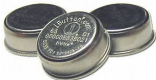
Mynd 8. IButton DS1922L hitastigs sírítar notaðir til að mæla hitastig í afurð og umhverfishita
