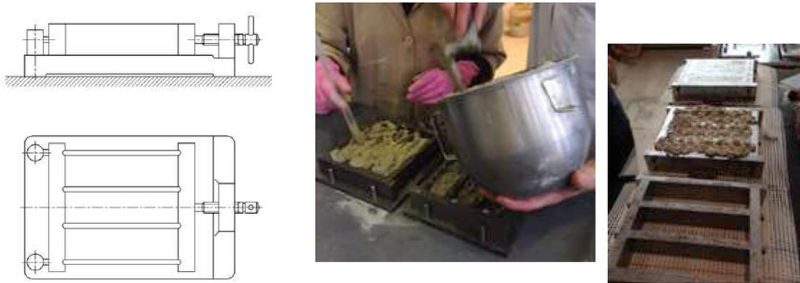
Figura 1 – Moldagem das argamassas: (esquerda) molde metálico normalizado, (centro) argamassa moldada em moldes metálicos e, (direita) argamassa moldada sobre tijolo
