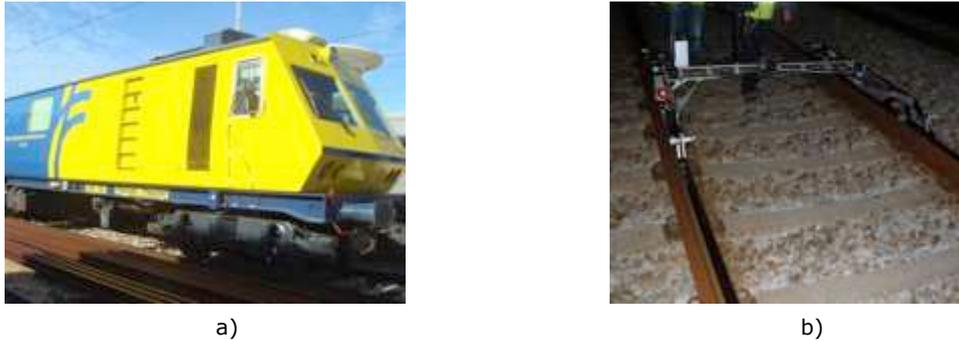
Figura 6 – Equipamento utilizado na medição das irregularidades da via: a) EM 120; b) Vogel RMF<sup>2.3E</sup>.
