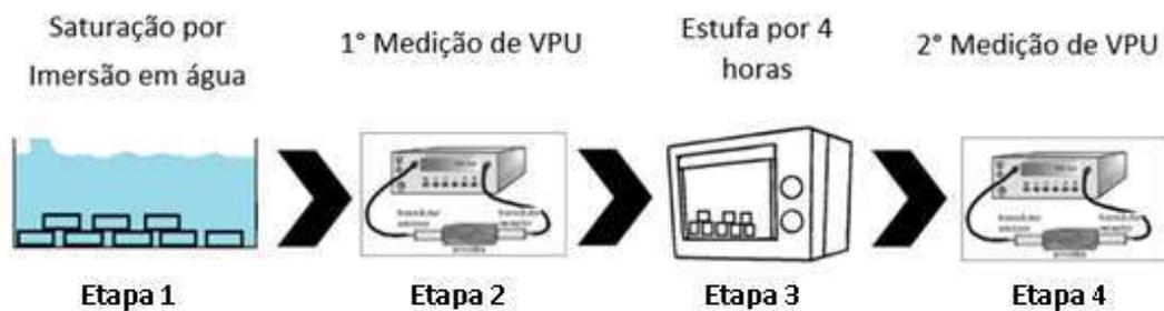
Figura 2: Procedimento para a determinação da velocidade do pulso ultrassônico nos corpos de prova
