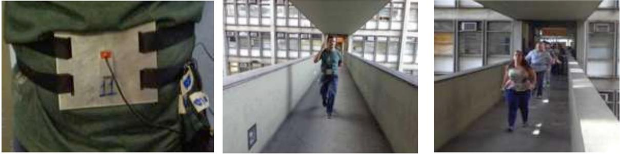
Figura 19 - Monitoração experimental dinâmica: placa com acelerômetro acoplado ao centro de massa e pedestres caminhando sobre a passarela (1 e 8 pedestres:  $f = 2,45$  Hz: ressonância)
