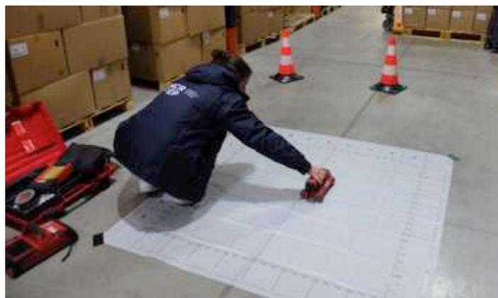
Figura 3.2- Ensaio bidireccional com o *Ferroskan® PS 200* para identificação de armaduras na laje do piso térreo
