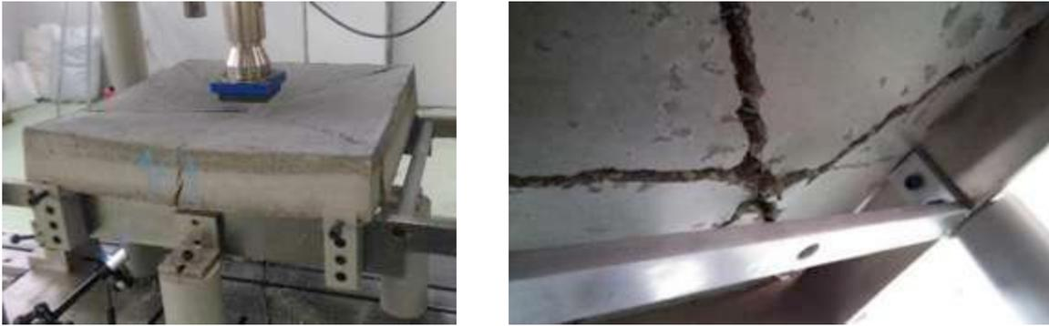
Figura 8 – Ensaio de determinação da capacidade de absorção de energia
