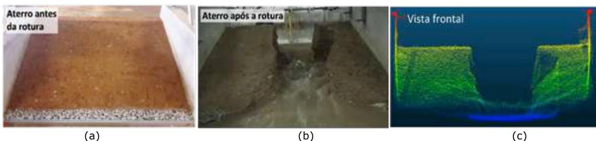
Figura 12 – Processamento dos dados adquiridos com o KINECT no software Cloud Compare
