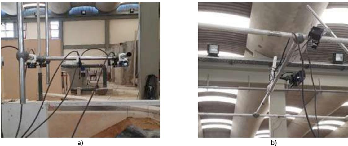
Figura 3 – Instrumentação colocada a montante da barragem de aterro: a) sondas de nível acústicas;
