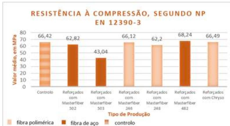
Figura 4 – Resultados obtidos para resistência à compressão, em cubos
