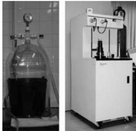
Figura 6 - Campânula de vácuo utilizada na determinação da porosidade pelo princípio de Arquimedes e porosímetro de mercúrio por intrusão (MIP) (fonte FCT NOVA).
