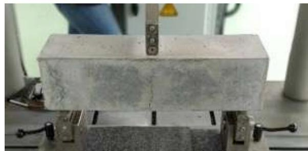
b) Fissura obtida para um prisma reforçado com fibras
