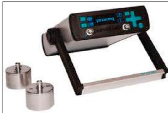
Figura 1 – Equipamento para ensaio, com destaque aos transdutores
