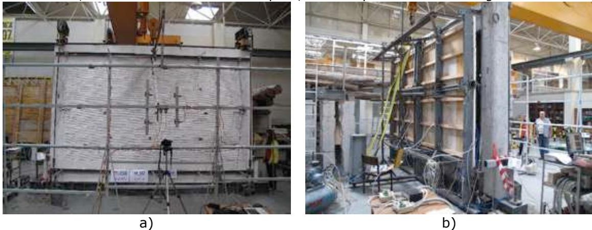
Figura 3 - Setup experimental para ensaio de paredes de enchimento sujeitas a ações distribuídas para fora do seu plano com recurso a *airbags*: a) vista frontal; e b) Vista traseira.
