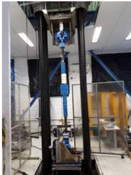
Figura 5 - Escora instalada no sistema de prensa. A região protegida, indicada pela seta, mostra o local de instalação dos extensômetros que constituíram as células de deformação, as quais serviram para o monitoramento das forças aplicadas nas escoras durante o ajuste da superelevação das vigas curvas
