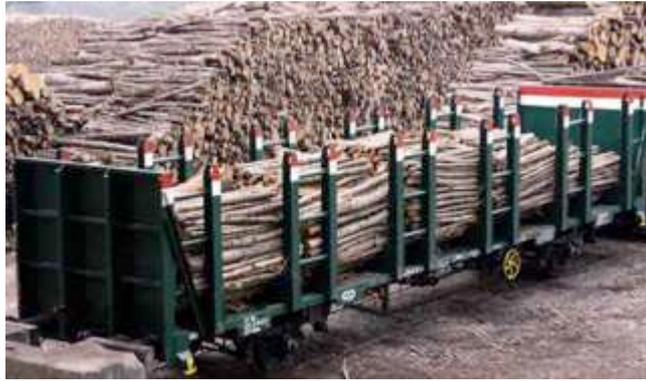
Figura 2 – Vagão da série *Kbs* de transporte de madeira
