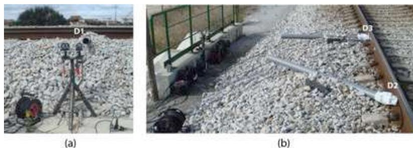
Figura 7 –Pontos de apoio do sistema laser para medição do deslocamento do carril: (a) no maciço de ancoragem da catenária e (b) na estrutura de betão da PH
