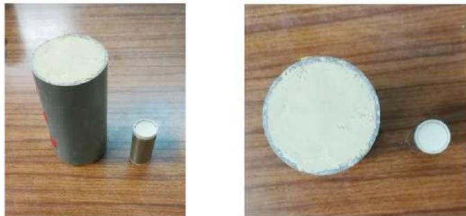
Figura 3 - Amostras de argila compactada nos moldes grandes e pequenos.
