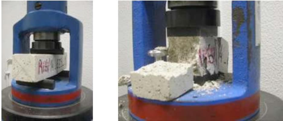
Figura 4 – Ensaio para determinação da resistência das argamassas: (esquerda) à flexão e (direita) à compressão
