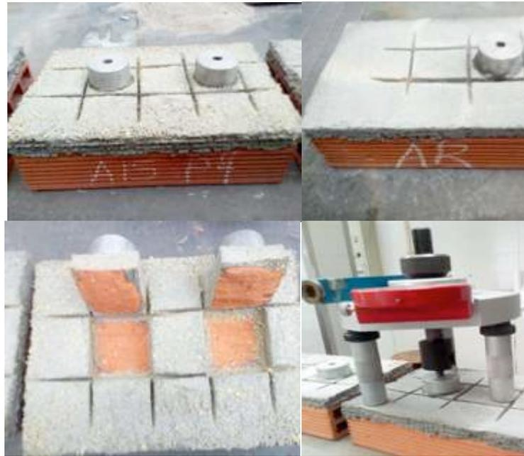
Figura 8 - Ensaio de arrancamento
