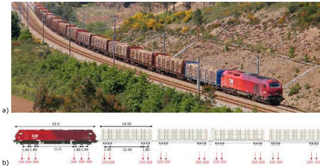
Figura 3 - Comboio de mercadorias locomotiva 6000 com vagões *Sgnss*: a) perspetiva geral; b) esquema de cargas
