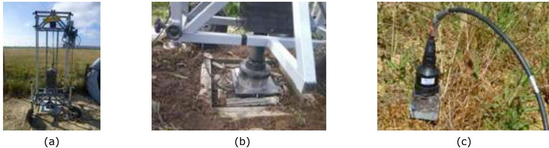
Figura 4 – Equipamento utilizado na componente experimental do ensaio SASW: a) equipamento para queda de peso; b) célula de carga; c) acelerómetro.
