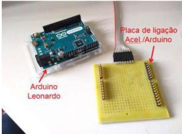
Figura 5 - Arduino Leonardo e placa de ligação com os acelerômetros.
