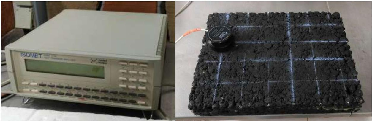
Figura 5 – a) Equipamento de medição ISOMET 2104 (FCT-UNL); b) pontos de medição na laje
