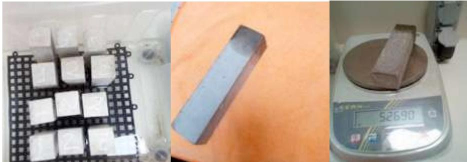
Figura 10 – Fases do ensaio de absorção de água por capilaridade
