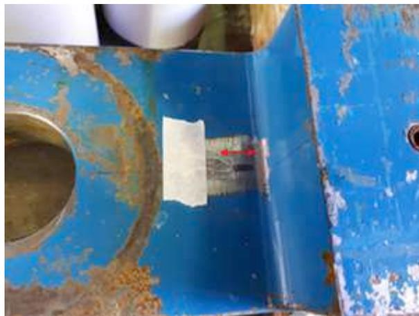
Figura 2 - Extensômetro unidirecional instalado na chapa de extremidade. A seta indica o sentido das leituras de deformação
