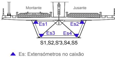
Figura 9. Secção transversal com localização dos extensómetros no caixão da ponte.
