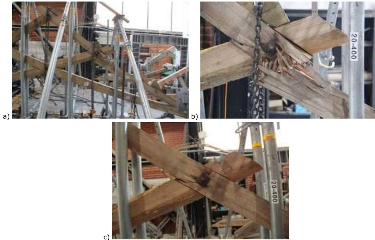
Figura 12 – Rotura da Asna 2: a) vista geral da rotura da asna; b) rotura do nó; c) nó de ligação antes do ensaio.
