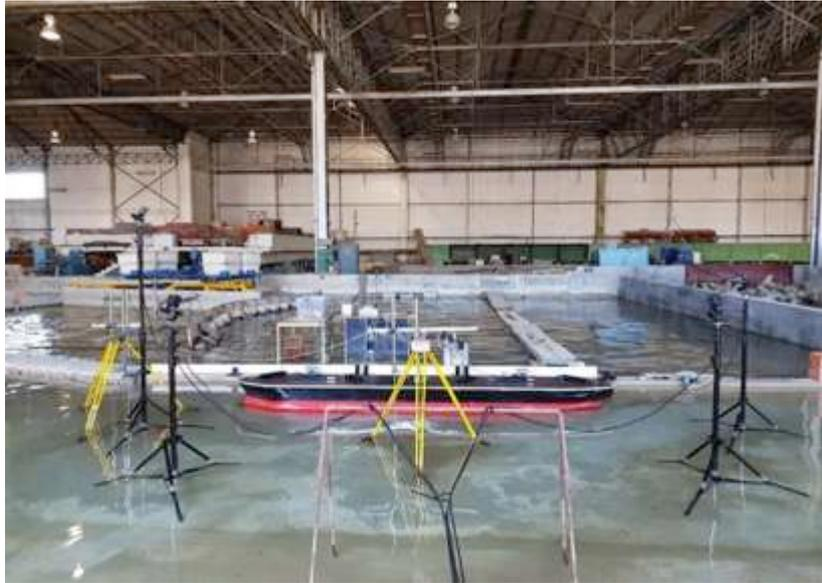
Figura 6 - Disposição do Sistema OptriTrack
