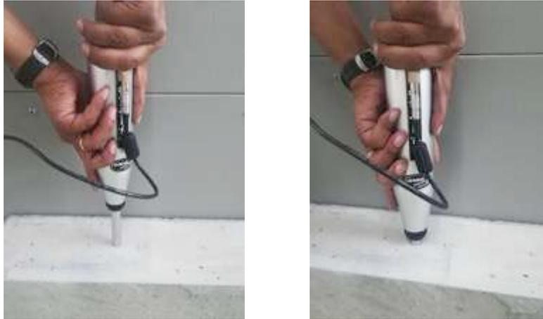
Figura 6 – Ensaio esclerométrico
