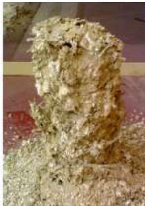
Figura 1 – Desagregação de um provete cilíndrico de betão após exposição a 1000 °C. (Lourenço, et al., 2006)
