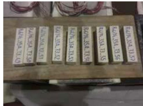
Figura 3 – Processo de cura dos provetes moldados sobre tijolo
