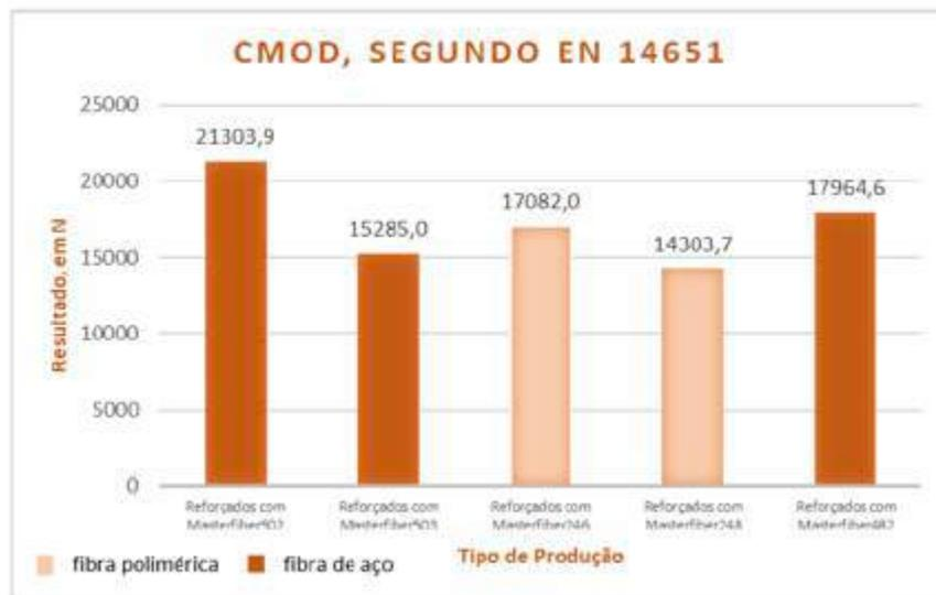
Figura 9 – Resultados do ensaio de CMOD, em prismas reforçados com fibras
