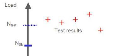
Figura 6 – Conjunto de ensaios com valores de rutura diferente
