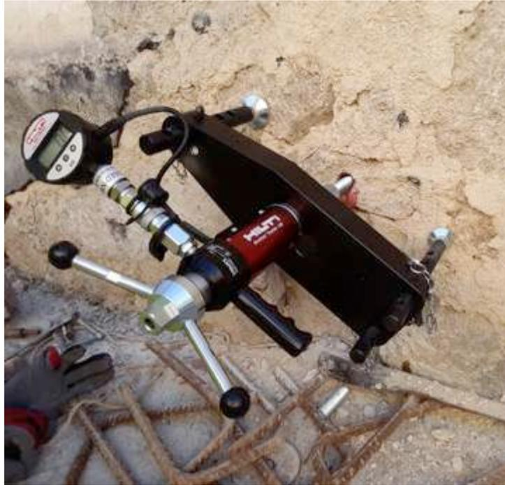
Figura 1 – Ensaio de tração em alvenaria de pedra com recurso ao equipamento HAT30
