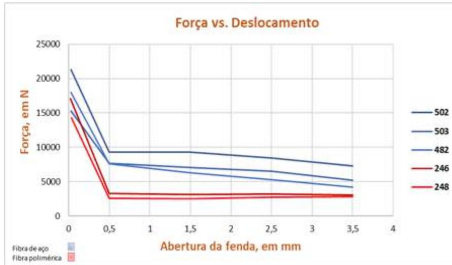
Figura 10 – Gráfico representativo da força versus abertura da fenda, no ensaio de CMOD
