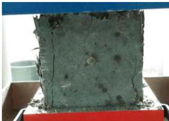
Figura 7 – Ensaio de resistência à compressão de provetes.
