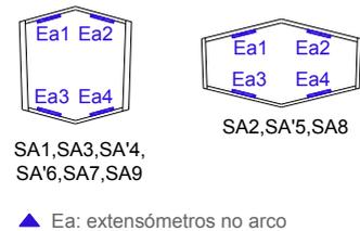
Figura 10. Secção transversal dos arcos com localização dos extensómetros.
