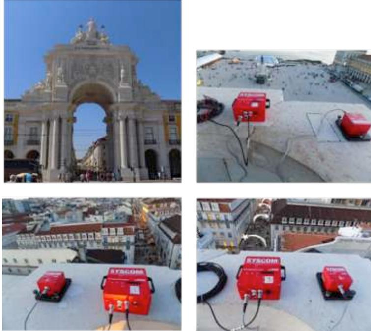
Figura 8 - Teste de vibração ambiental realizado no arco da Rua Augusta em Lisboa. Visão geral do arco e configuração do teste (adaptado de [91]).
