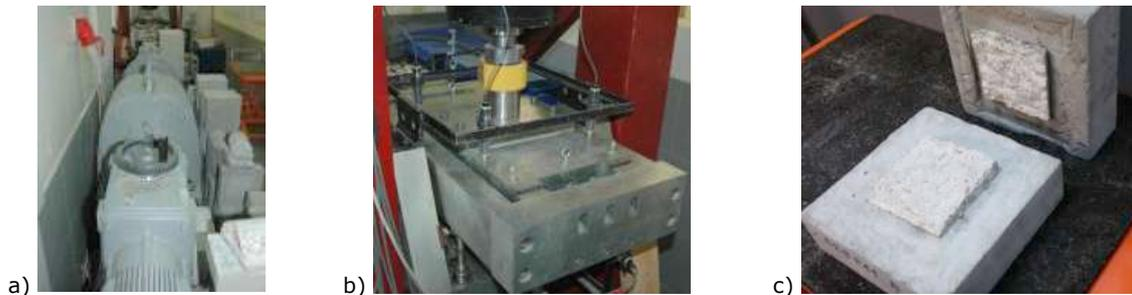
Figura 11 – Ensaios de compressão e corte nas amostras de junta (Arêde et al. 2017): a) vista geral do equipamento; b) caixa de corte; c) amostras de junta após ensaio de corte
