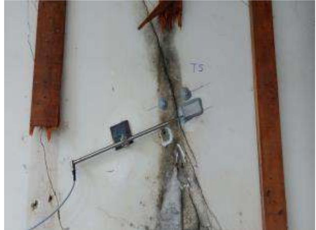
Figura 8 - LVDT e pinos embutidos na alvenaria para utilização do Tensotast - Base T5.
