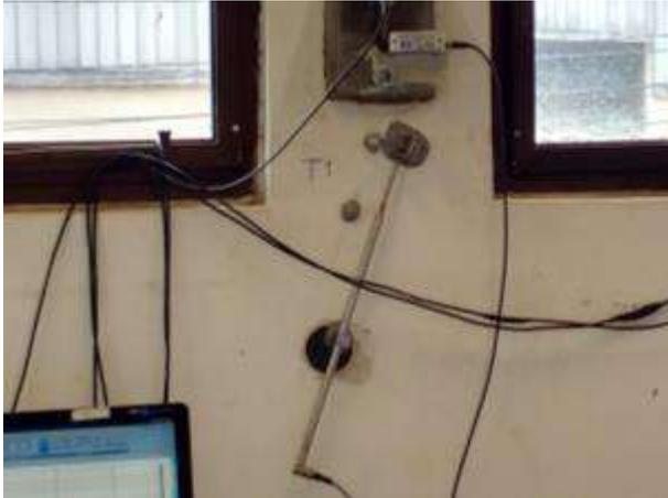
Figura 7 - LVDT e pinos embutidos na alvenaria para utilização do Tensotast - Base T1.
