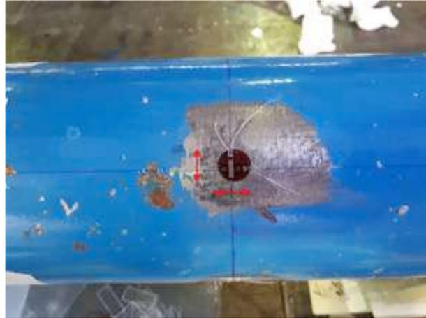
Figura 4 - Extensômetro bidirecional instalado no tubo da escora. As setas indicam os sentidos das leituras de deformações
