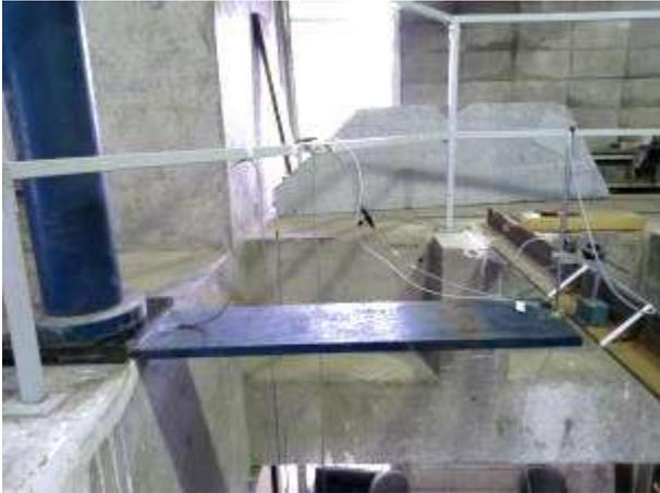
Figura 22 – Vista geral da chapa, engastamento e sensores instalados na extremidade
