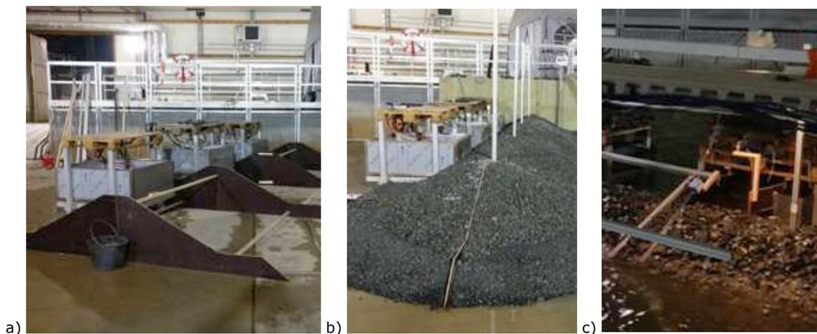
Figura 3. Reservatórios para medição de galgamentos. a) e b) Colocação dos reservatórios durante a construção do modelo; c) Aspeto geral da entrada de um daqueles reservatórios (sonda para medição do espraio, sonda acústica para identificação de galgamentos, régua graduada)
