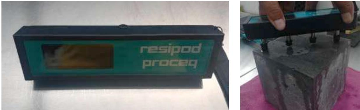
Figura 4 – Equipamento e medição da resistividade elétrica do betão.
