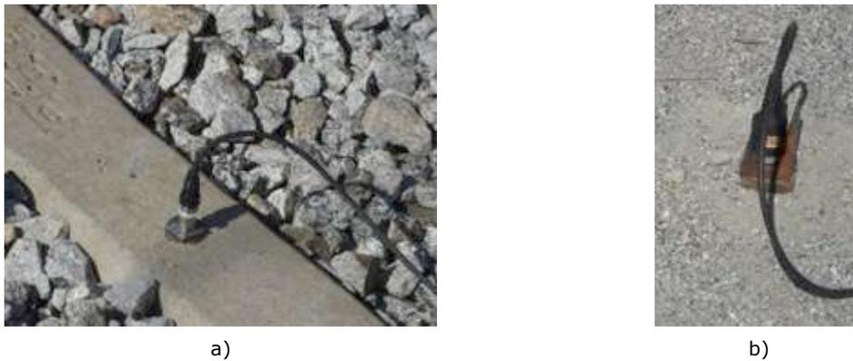
Figura 14 – Acelerómetros: a) colado na travessa; b) montado numa estaca de aço cravada no maciço.
