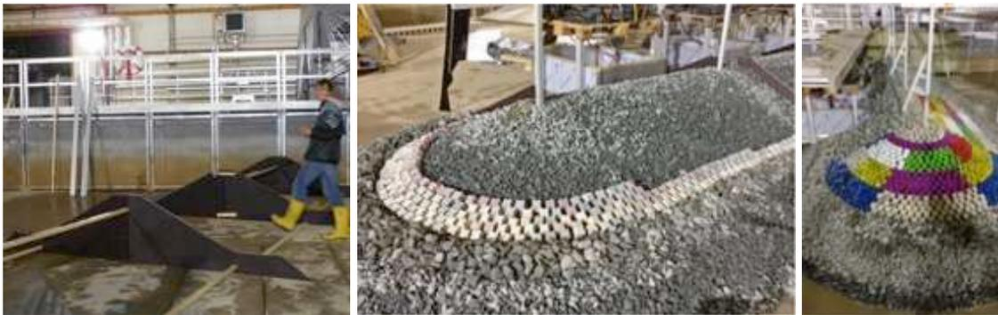
Figura 2. Várias etapas da construção do modelo
