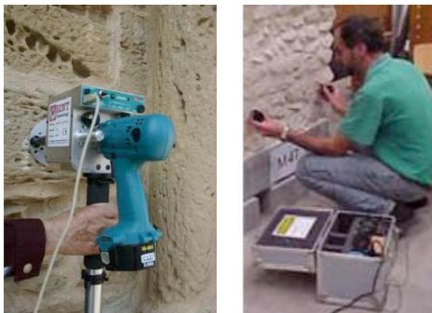
Figura 7 - Testes utilizando o equipamento DRTMS (à esquerda) [53] e o de ultra-sons (à direita) [83].
