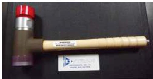
Figura 9 - Ensaio 2: Martelo de impacto Dytran
