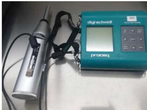
Figura 5 – Esclerómetro.
