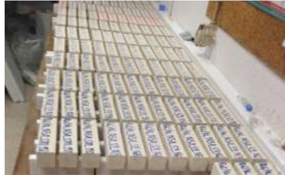
Figura 2 – Processo de cura dos provetes moldados em moldes metálicos
