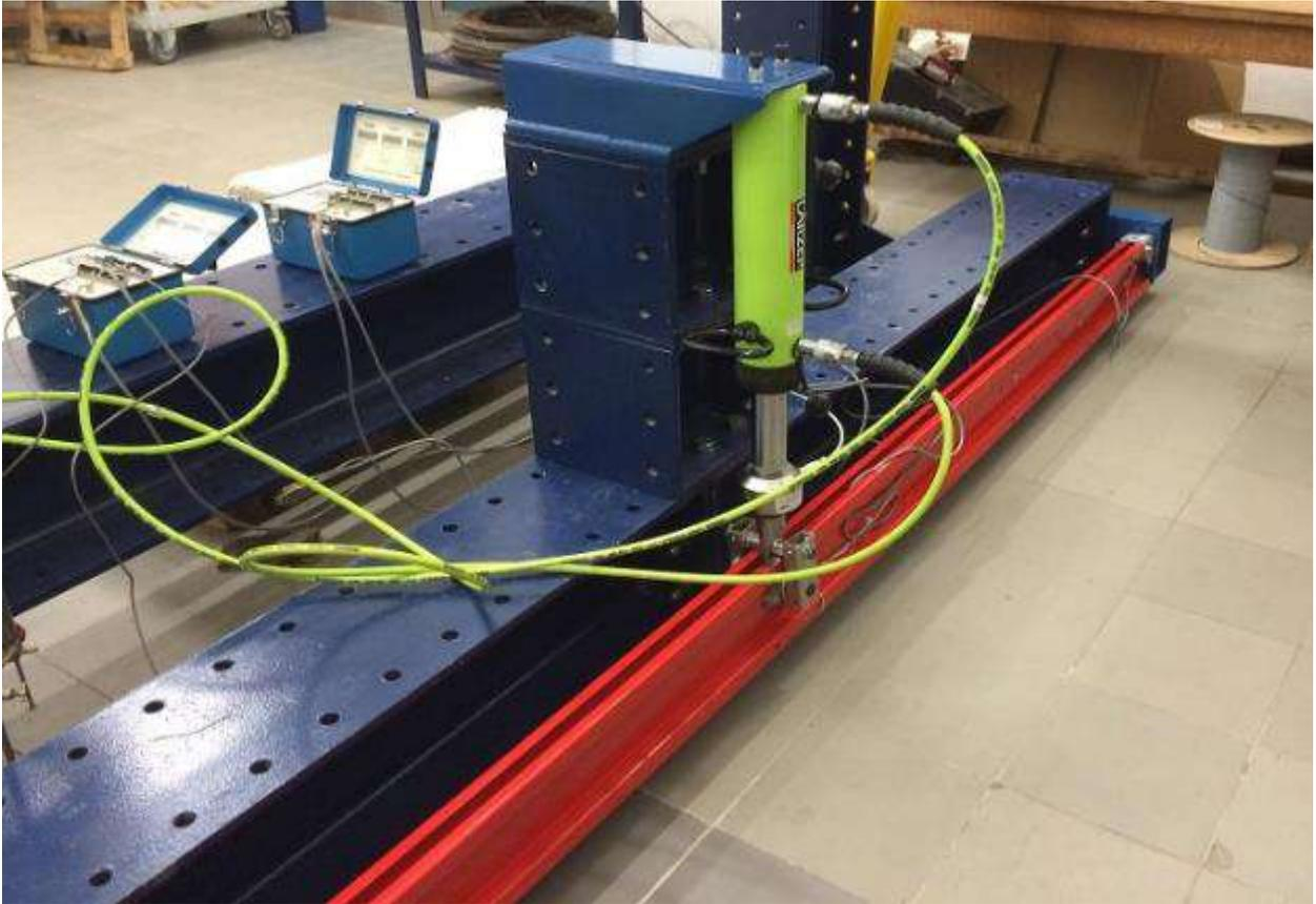
Figura 5 – Dispositivo de ensaios com acessórios, sistema de aquisição de dados e viga monocarril.
