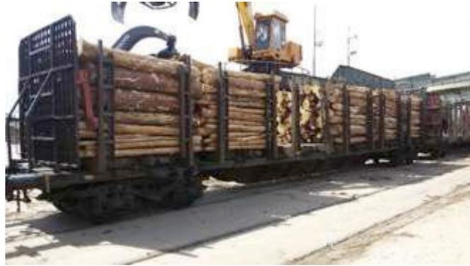
Figura 4 - Vagão da série Sgnss de transporte de madeira
