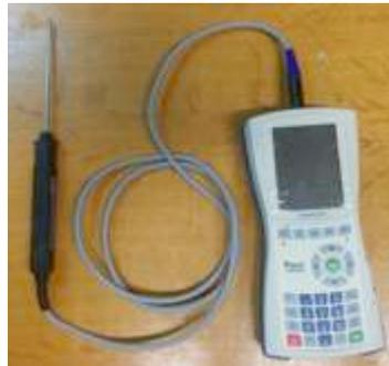
Figura 5 - Equipamento usado para a medição das propriedades térmicas.
