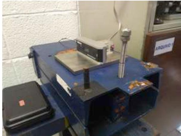
Figura 11 - Vista parcial do arranjo para medir inclinações.
