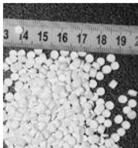
Figura 6 – Pellets em PVC utilizados para modelar o leito móvel.
