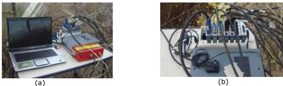
Figura 5 – Sistema de aquisição montado no campo experimental: (a) sistema completo e (b) pormenor da unidade de aquisição compacDAQ 9172
