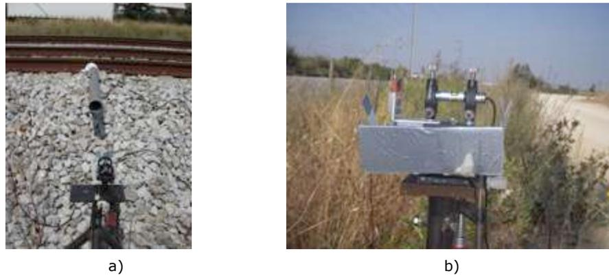
Figura 15 – Sistema laser/PSD: a) vista geral; b) pormenor do emissor laser (sem proteção).
