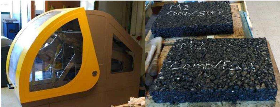
Figura 4 – a) Compactador de rolo (IST-LVCT); b) lajes de mistura betuminosa
