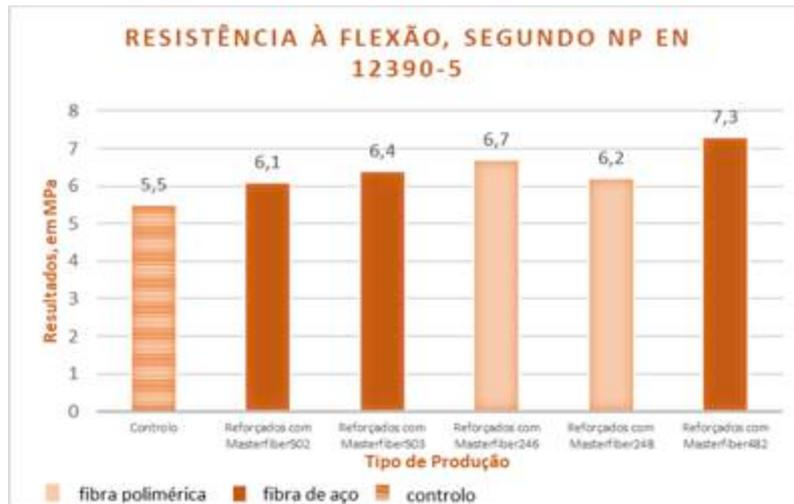
Figura 7 – Gráfico relativo aos resultados do ensaio de resistência à flexão
