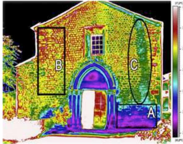
Figura 4 - Termograma de um levantamento efetuado num edifício histórico [40].
