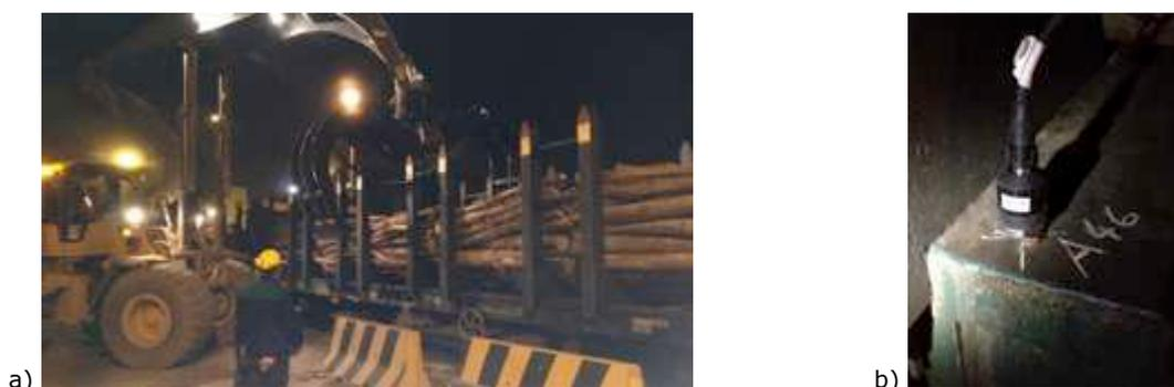
Figura 5 - Ensaio dinâmico do veículo *Kbs*: a) remoção da estiva central; b) fixação do acelerómetro
