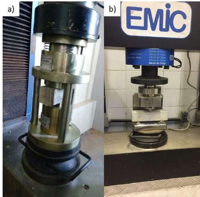
Figura 3-a: Ensaio compressão axial; b: Ensaio tração na flexão
