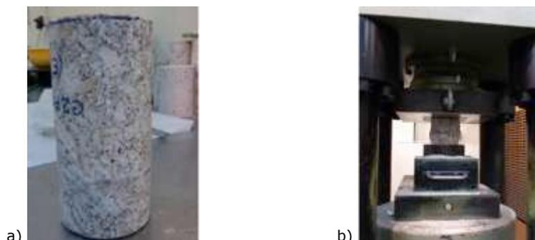
Figura 10 - Ensaios de caracterização mecânica da pedra (Arêde et al. 2017): a) amostra de pedra granito; b) equipamento para ensaios de compressão
