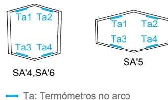
Figura 12. Secção transversal dos arcos com localização dos sensores de temperatura.
