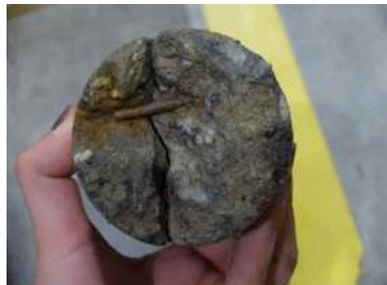
d) Micro-carote de 7.5cm extraída sobre uma junta. A imagem da esquerda mostra a superfície interior das duas metades da carote e marca a altura do corte na laje que materializa a junta de indução de fendas
