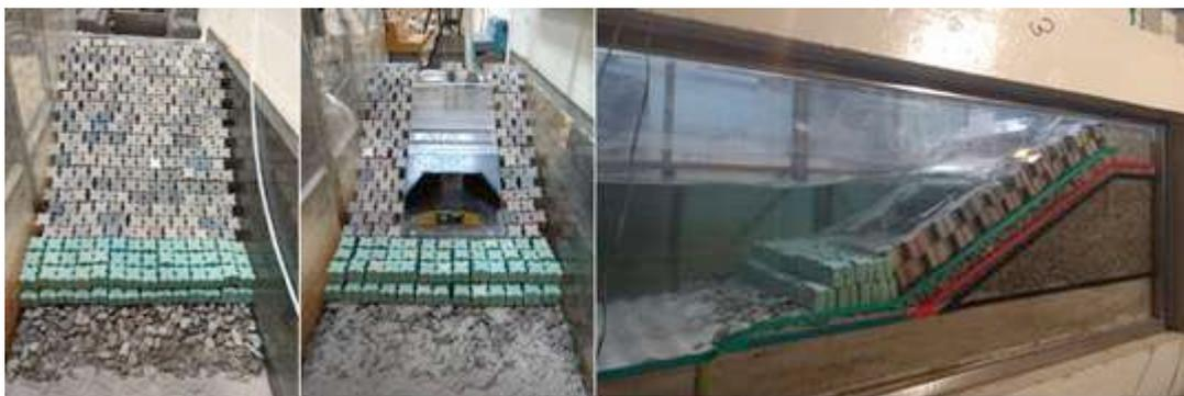
Figura 5 – Modelo físico do quebramar sem (à esquerda) e com (ao centro) o WEC híbrido antes do ensaio, e (à direita) o modelo com o WEC híbrido durante a realização do ensaio.
