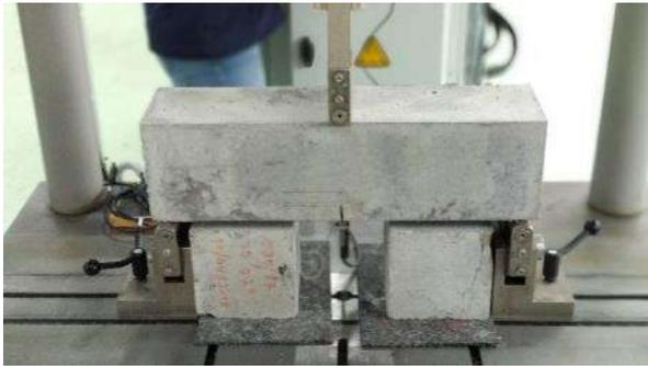
a) Colocação de um prisma no equipamento de ensaio
