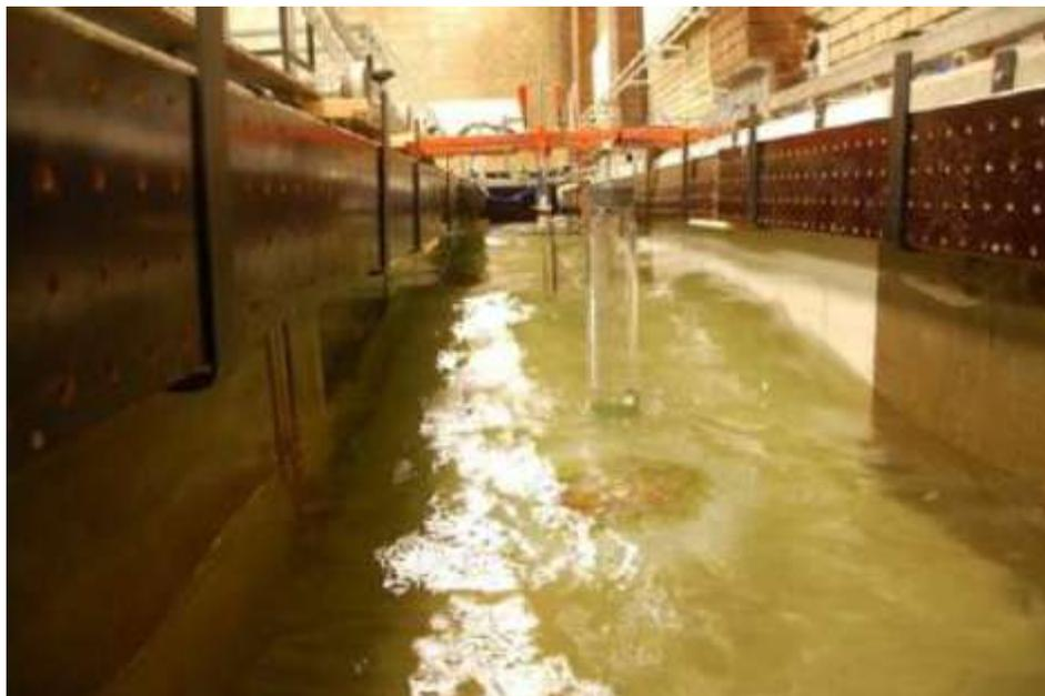
Figura 2 - Modelação física de erosões localizadas em fundação monopilar, sujeita à ação de ondas e correntes na Universidade de Aalborg (Fazeres-Ferradosa, 2018).
