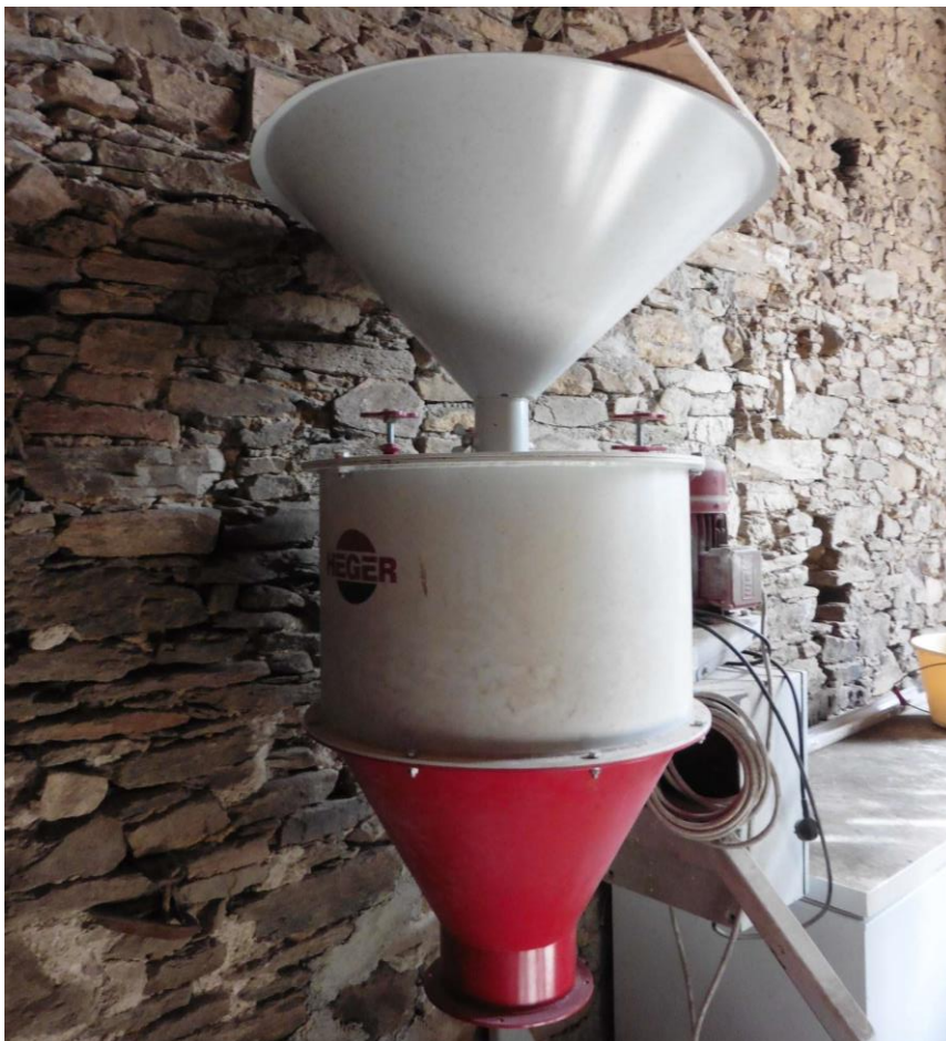
The Heger (Moulins d'Alma) dehulling centrifuge
