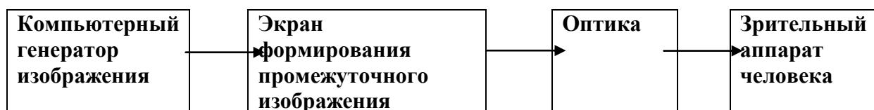
Рис.2 – Технологическая цепочка получения трёхмерной визуальной модели
