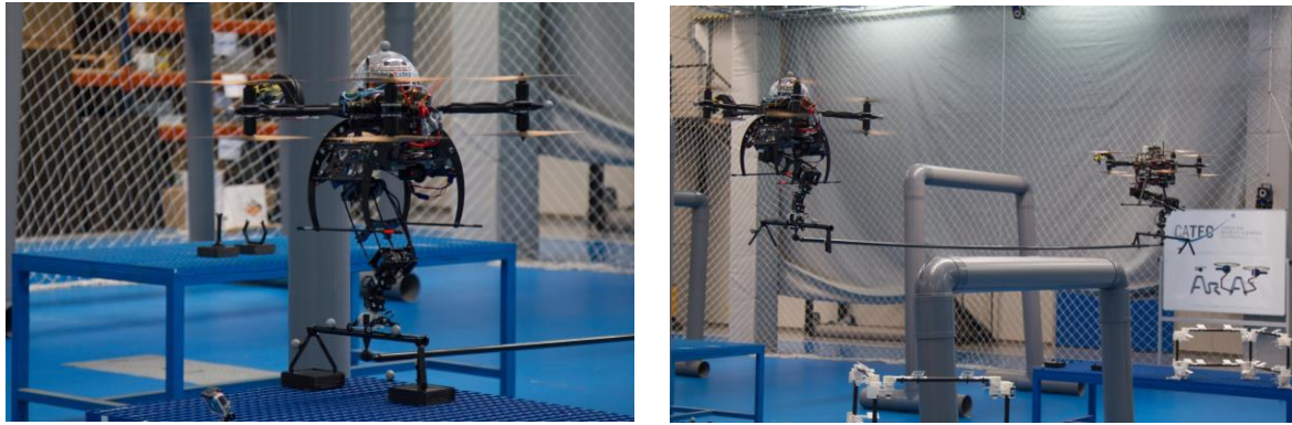
Figura 5: Agarre y transporte de la barra por parte de las dos aeronaves del proyecto ARCAS.
