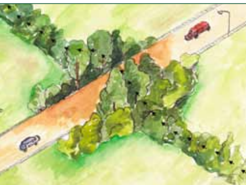
Przyjazne nietoperzom metody utrzymania zwartej linii zadrzewień i zakrzewień przy drogach o wysokim natężeniu ruchu, „utrzymujące” zwierzęta na bezpiecznej wysokości nad drogą (Rys. BK)
