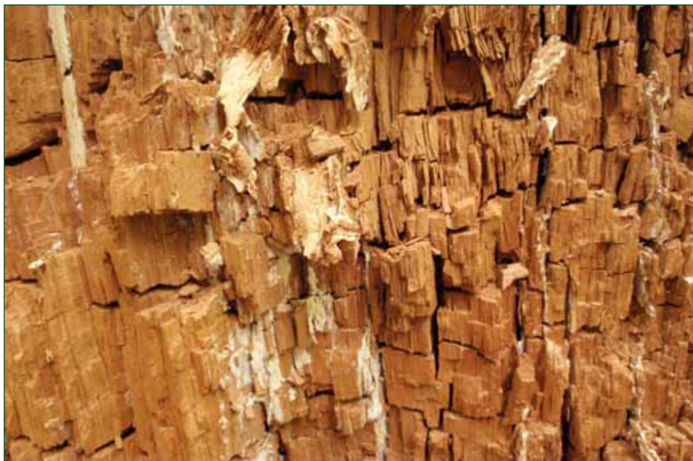
Brunatna zgnilizna pnia (Fot. MS)
