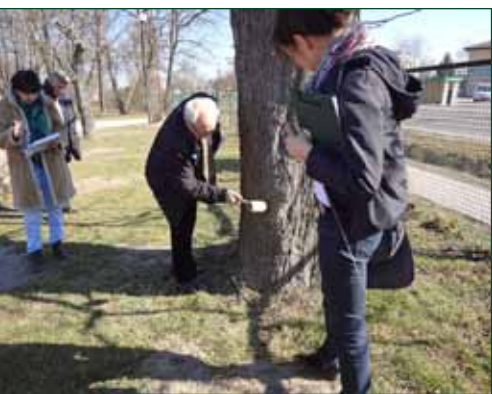
Badanie pnia i korzeni drzewa z użyciem prostych narzędzi: gumowego lub drewnianego młotka i metalowej sondy (Fot. PŚ, MS)
