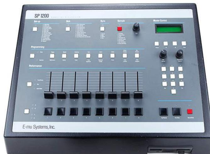
Figura 2 - E-mu SP 1200 (1987) – O sampler SP 1200, da E-mu, é uma mistura de sampler e bateria eletrônica, com a presença de botões e sliders. Fonte: [www.vintagesynth.com](http://www.vintagesynth.com)
