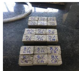
Figura 4. Cubos de mortero mezcla CHn
