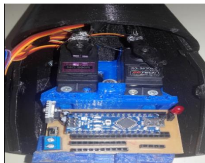
Figura 7. Encaje de circuitería en la prótesis impresa
