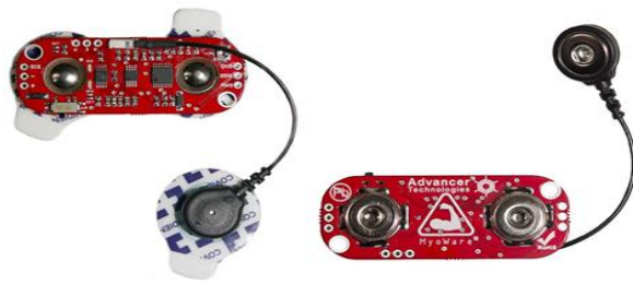
Figura 38. Sensor de músculo mioeléctrico (Modelo SEN_0708)
