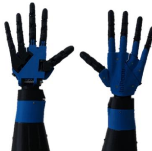
Figura 6. Prótesis impresa y ensamblada
