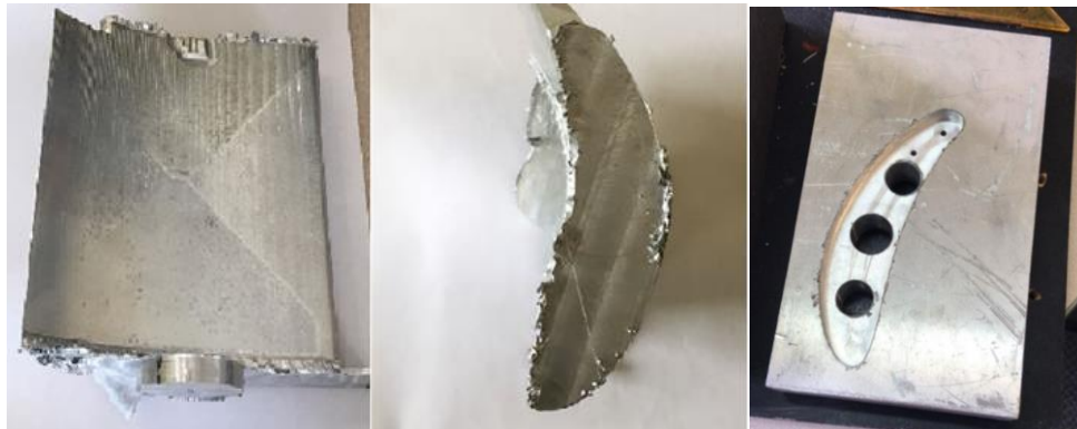
Figura 12. Álabe y soporte mecanizado
