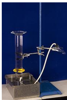
Figura 11. Montaje para la obtención de \text{CO}_2 a partir de \text{CH}_3\text{COOH}
