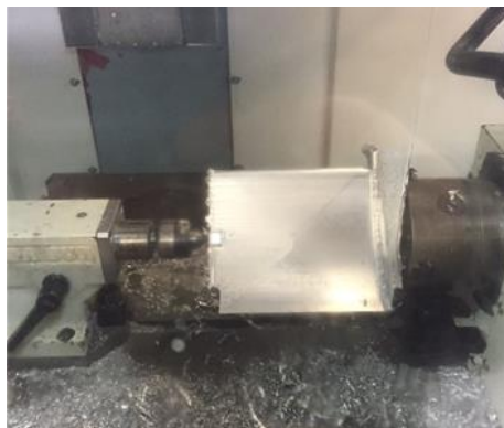
Figura 11. Maquinado del álabe en la CNC
