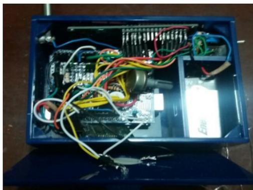
Figura 16. Módulo receptor del sistema de cronometraje
