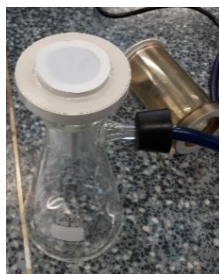
Figura 2. Membrana MARTIN ubicada en el sistema de filtración al vacío
