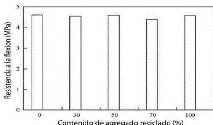
Figura 3. Resistencia a la flexión en concretos con diferentes porcentajes de sustitución [4]
