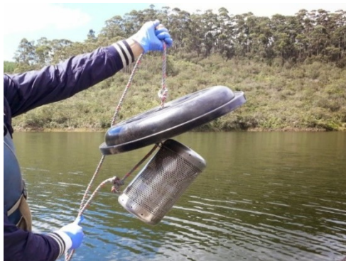
Figura 3. Despliegue de MP en un cuerpo de agua, usando canastillas de acero inoxidable
