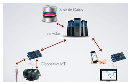
Figura 1. Estructura General de una red IoT
