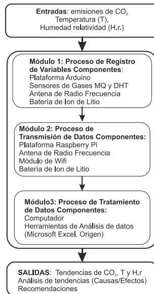
Figura 1. Esquema del sistema de monitoreo de variables atmosféricas
