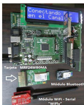
Figura 8: Prototipo de nodo coordinador de red y opciones de módulos para integración de gateway Bluetooth o WiFi
