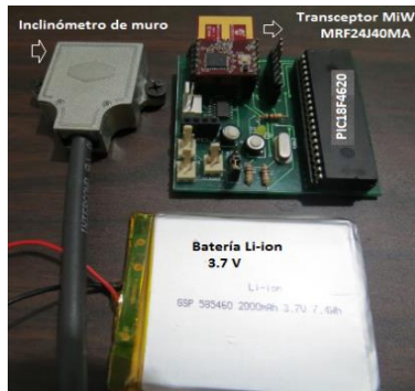
Figura 6: Prototipo de nodo sensor inalámbrico basado en inclinómetro biaxial para fijación en muro
