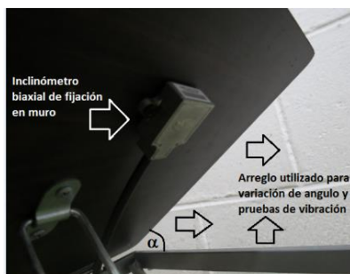
Figura 9: Disposición de elementos para la realización de pruebas de variación angular y de detección de perturbaciones debidas a vibración
