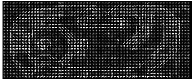
Abbildung 2. Beispiel für automatische Zeichenerkennung der Hieroglyphe /chi/ aus der Dresdner Mayahandschrift mit Hilfe eines Histogram of Oriented Gradients (HOG) (Feldmann, Bogacz, Prager, Mara 2017, Abb. 3).
