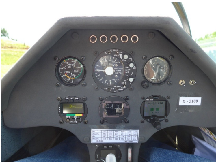
Bild 20: Instrumentenbrett des Flugzeuges des Autors (Discus 2b)
