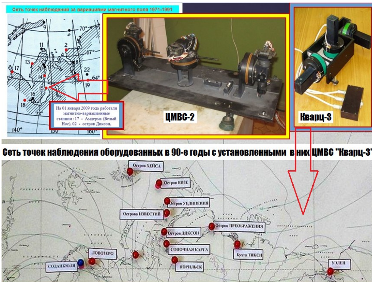
Рис.1. Сеть пунктов и точек наблюдений с помощью различных ЦМВС в районе КС в период с 1971 по 1991гг (схема взята из публикации А.Н. Зайцева [28]) и в период после 1992 г (схема взята из публикации Б.А. Белова и др.[18]).
