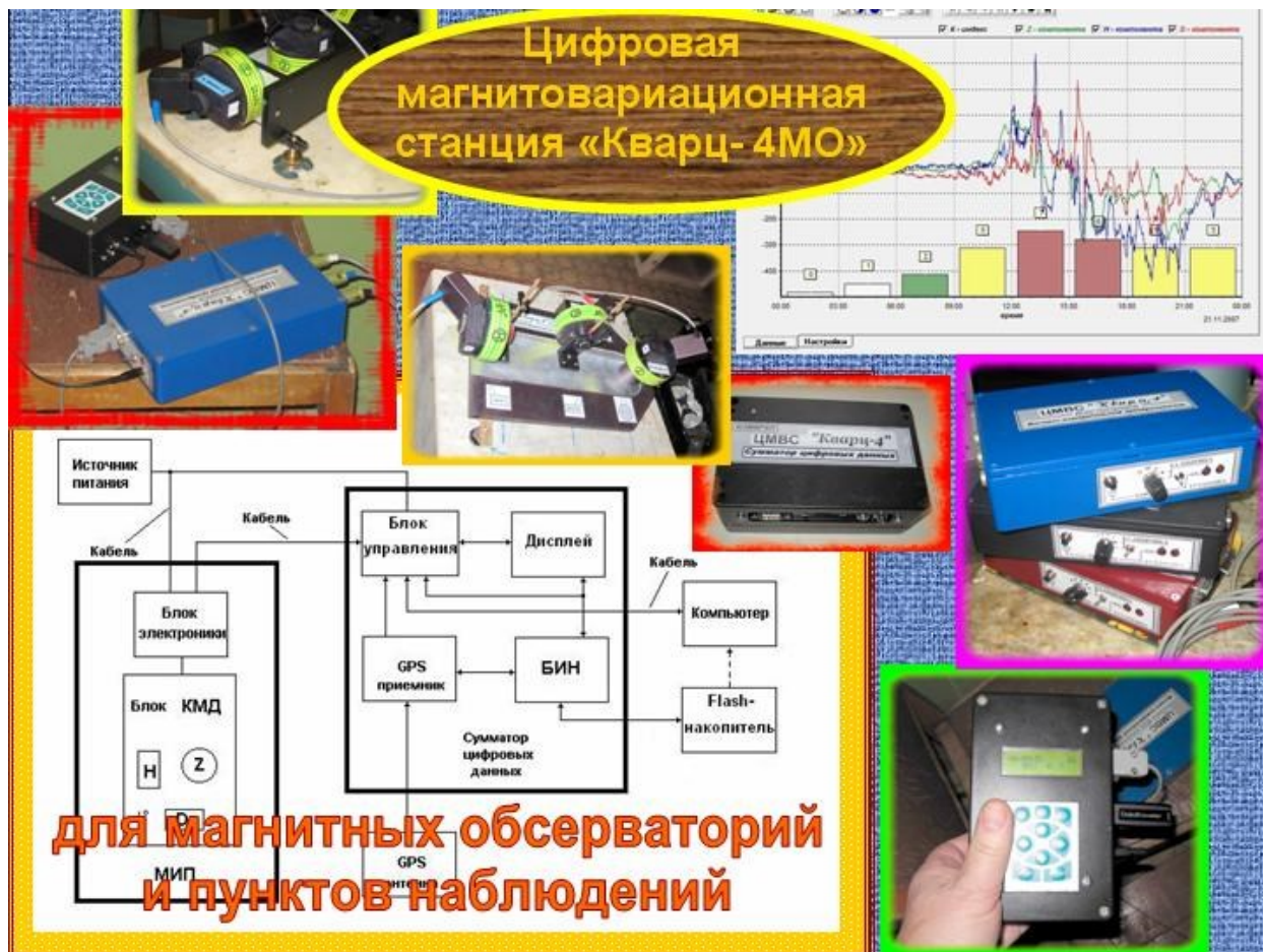
Рис.3. Одна из моделей ЦМВС «Кварц-4МО» для МО и редко обслуживаемых ПН.
