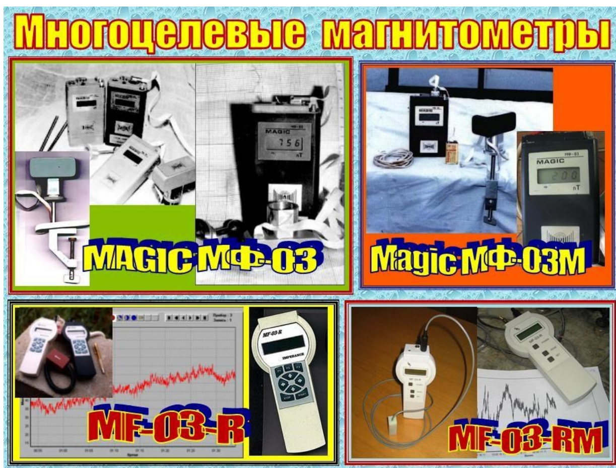
Рис.5. Малогабаритные цифровые феррозондовые магнитометры для научных исследований созданные в ИЗМИРАН.
