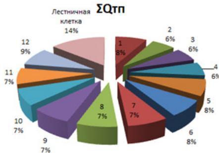
Рис. 2. Анализ величин теплового потока через ограждающие конструкции поэтажно
