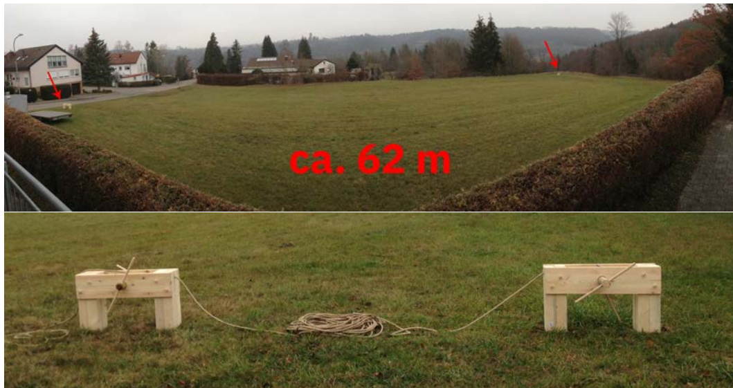
ABB. 52 | Feldversuch mit nachgebauten Seilwinden, Nachbau L. C. Bossert, im Maßstab 1 : 2
