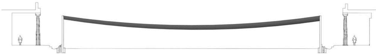
ABB. 25 | Schematischer Querschnitt durch ein Sonnensegel über das Forum für die Einfassungen der Serie A
