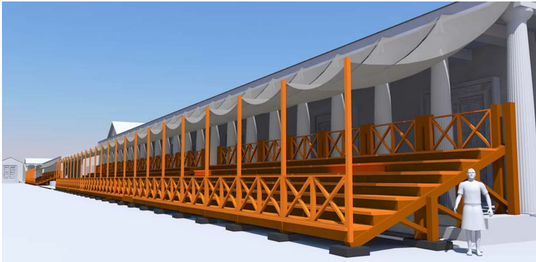
B Tribünenkonstruktion in maximaler Ausfertigung mit Sonnensegel
