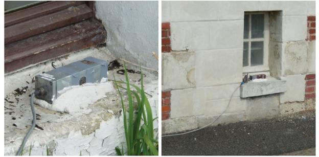
FIGURE 4 : DISPOSITIF DE SUIVI DES VIBRATIONS
