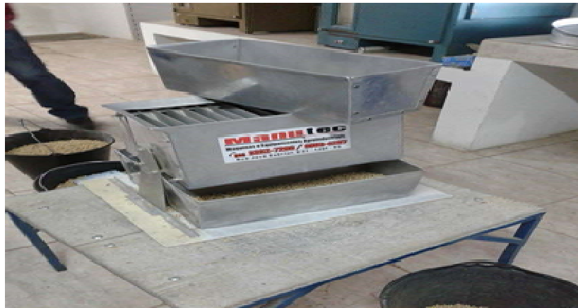
Figura 5 – Quarteador utilizado para homogeneizar amostras e reduzi-las a amostras representativas
