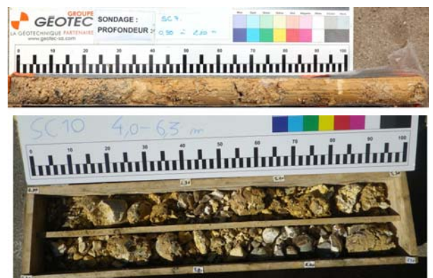
FIGURE 9 : REMBLAI ARGILEUX DE LA DIGUE (EN HAUT), ARGILE A SILEX (EN BAS)
