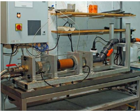
FIGURE 2 : L'ESSAI D'ÉROSION DE CONDUIT « HET » DE IRSTEA UTILISÉ PAR GEOPHYCONSULT
