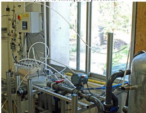
FIGURE 6 : L'ESSAI D'ÉROSION DE CONTACT DE GEOPHYCONSULT
