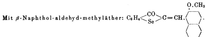
In konzentrierter, methylalkoholischer Lösung. Verharzt etwas. Gelbe Krystalle, leicht löslich in den gebräuchlichen, organischen Lösungsmitteln, schwerer in Benzin vom Sdp. 90—100°, krystallisiert daraus in gelben glänzenden Krystallen (unter dem Mikroskop flache Tafeln) vom Schmp. 127—128°. Bei zu großer Konzentration scheidet sich die Verbindung leicht ölig aus. Konzentrierte Schwefelsäure löst mit violetter Farbe, die beim Erwärmen in rot übergeht.
