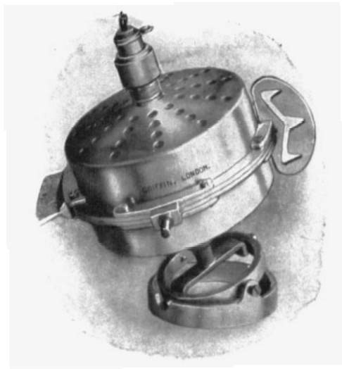
FIG. 5.—GYROSTAT ON GIMBALS.
