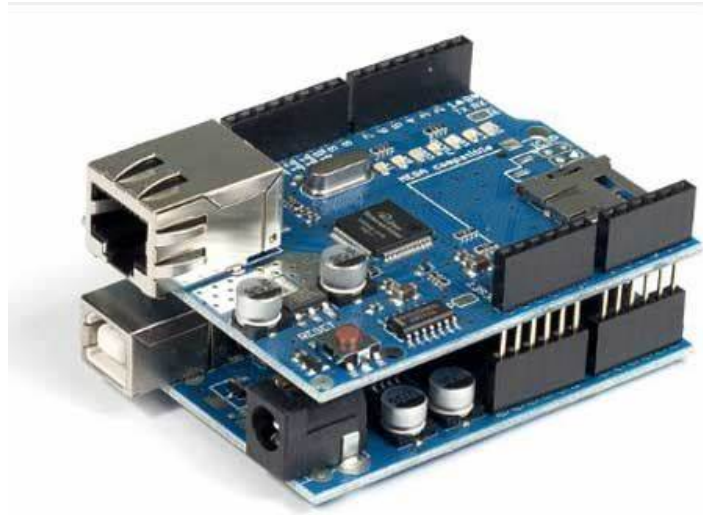
Figura 3.17: Arduino UNO conectado a Ethernet Shield.
