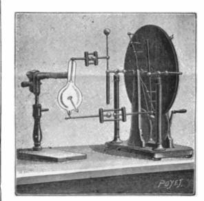
NEW STATIC MACHINE FOR RADIOGRAPHY.
