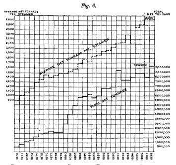
DIAGRAM SHOWING THE GROWTH OF TRAFFIC AND THE INCREASED TONNAGE CAPACITY OF STEAMERS FROM 1870 TO 1898.
