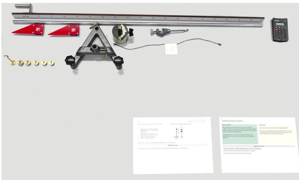
Abbildung 7.1: Station zur Teilaufgabe Versuch aufbauen und testen der Aufgabe Ausdehnung eines Gummibandes (oben: Materialien; unten: Informationen aus dem Aufgabenstamm und Aufgabenstellung mit Zwischenlösung)
