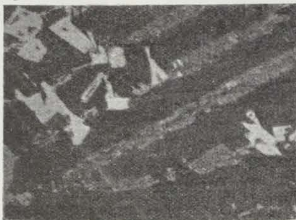
Fig. 8. — 61,6 at. 0/0 Mg + 38,4 at. 0/0 Cu attaqué par H Cl. \times 68 .
