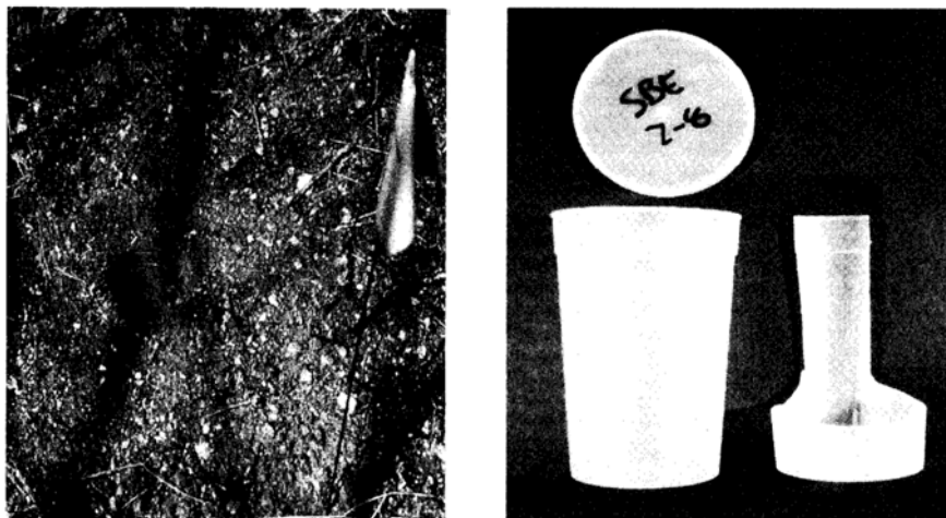
شکل شماره ۳-۹. الف) تله چاله‌ای کار گذاشته شده در خاک بیابانی. ب) یک ظرف نمونه‌گیری پروپیلنی بعنوان تله چاله‌ای و اسکوپ تله (سمت راست)، مورد استفاده در صید و نیز بیرون کشیدن ته مانده داخل تله که موقع کار گذاشتن به داخل تله می‌افتند. عکس از براندون پستلمایر.
