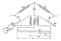
FIG. 2—ARRANGEMENT OF HEAVISIDE BRIDGE
