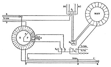
FIG. 3—ACTUAL ARRANGEMENT OF BRIDGE
