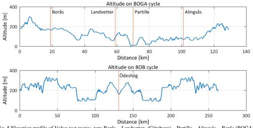
Fig. 5 Elevation profile of Volvo test routes. top: Borås – Landvetter (Göteborg) – Partille – Alingsås – Borås (BOGA); bottom: Boräs – Ödeshög – Borås (BOB)
