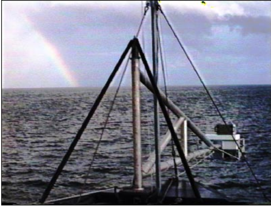
Abbildung 6.9: (Farbdruck findet sich als Abb. 11.1 auf Seite 177) Photo des montierten CFT-Instrumentes am boom auf dem Bug des Forschungsschiffes 'New Horizon' während der MBL/CoOP Forschungsfahrt im April/Mai 1995.
