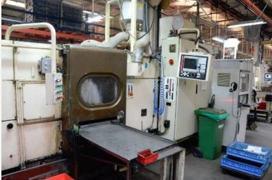
NILES DAM 6x32/2 CNC Diámetro Máximo 32 mm 6 Husillos
