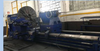
Torno GEMINIS 2000 de 3.000 mm entre puntos; volteo sobre carro 1.800; plato de Ø 1600 y luneta de 690. Marcado CE.
