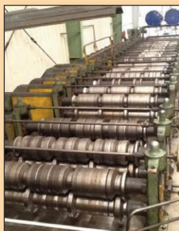
LINEA PERFILADO CHAPA TRAPEZOIDAL TACI-ARRASATE 18 EJES 1.250 MM.
