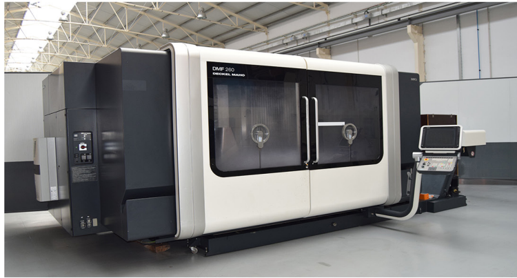
CENTRO MECANIZADO 5 EJES CONTINUOS DMG DMF 260 CNC Siemens 840D Recorridos(X/Y/Z): 2600/7000/7000 mm. Mesa Rotatoria (Eje C) Ø560 mm., Ejes C y B Continuos. SK 40 Ref.Interna. Evacuador de Viruta.Cargador 30 Htas..Año 2009
