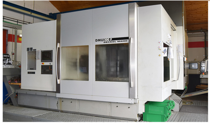
CENTRO MECANIZADO 5 EJES CONTINUOS DMG DMU 200P Heidenhain TNC 430. Recorridos(X/Y/Z): 1800/2000/1000 mm. Mesa Rotatoria:1.700x1.400 mm. Ejes C y B Continuos. SK 40 Evacuador de Viruta.Cargador Automatico 60 Htas..Año 2000
