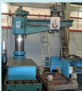
Taladro radial FORADIA MT-2000 Bloqueo hidráulico, Ø 75 x 2000 mm
