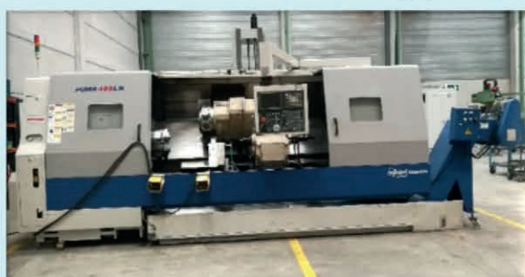
Torno cnc DAEWOO PUMA 400 LMB CNC FANUC 21i-TB E.P. 2000 x Ø 700 mm. Con Eje C y extractor virutas
