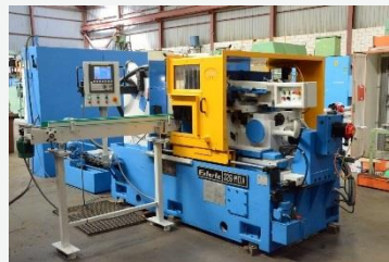
ESTARTA 326 MDA CNC Diámetro máximo a rectificar 150 mm Dimensión de la muela Ø 610x355 mm
