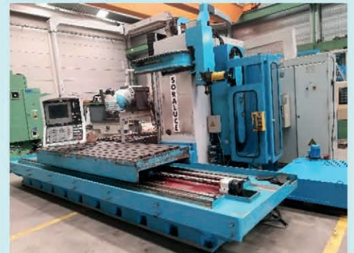
Fresadora SORALUCE TL-25 cnc HEIDENHAIN TNC-426 Recorridos: 2500x1000x1000 mm. Cabezal automático.
