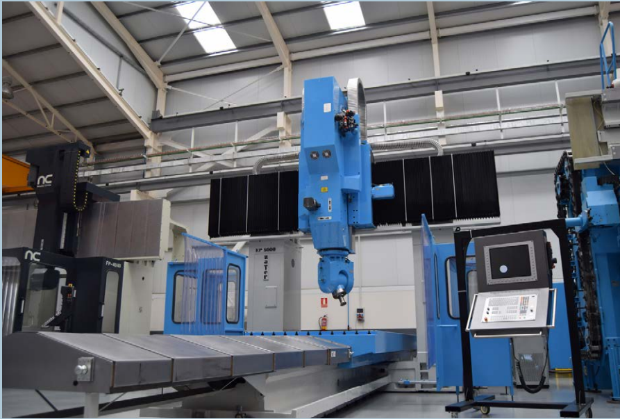
Ejemplo de una Zayer KP 5000 reconstruida a la que se instaló un CNC Heidenhain TNC 530 HSCI 19" nuevo.
