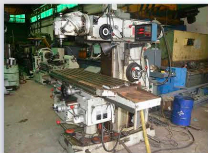
FRESADORA CORREA F3UE. Universal. Mesa: 1.400 x 340. Carnero motorizado
