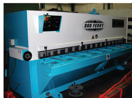
CIZALLA HIDRÁULICA HACO 3.000X 6 mm.
