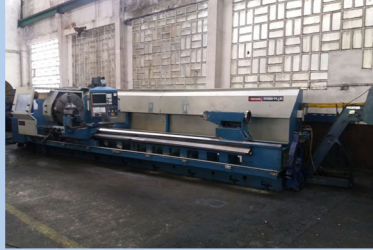
Torno Gurutzpe CNC Mod. AT600-5000/500 de 5000 y volteo de 1100 sobre bancada y 650 sobre carro. Control CNC Fagor 8050. Marcado CE.
