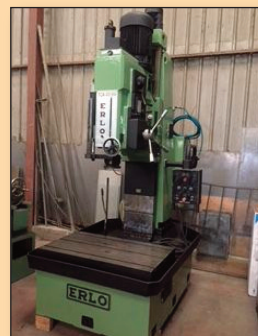
TALADRO ERLO TCA-70BV con cabezal múltiple 12 husillos
