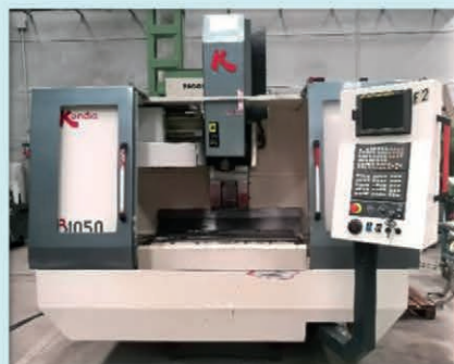
Centro de mecanizado KONDIA B-1050 cnc FANUC Recorridos 1000x500x610 mm. 4 eje, plato SPIRSIN.
