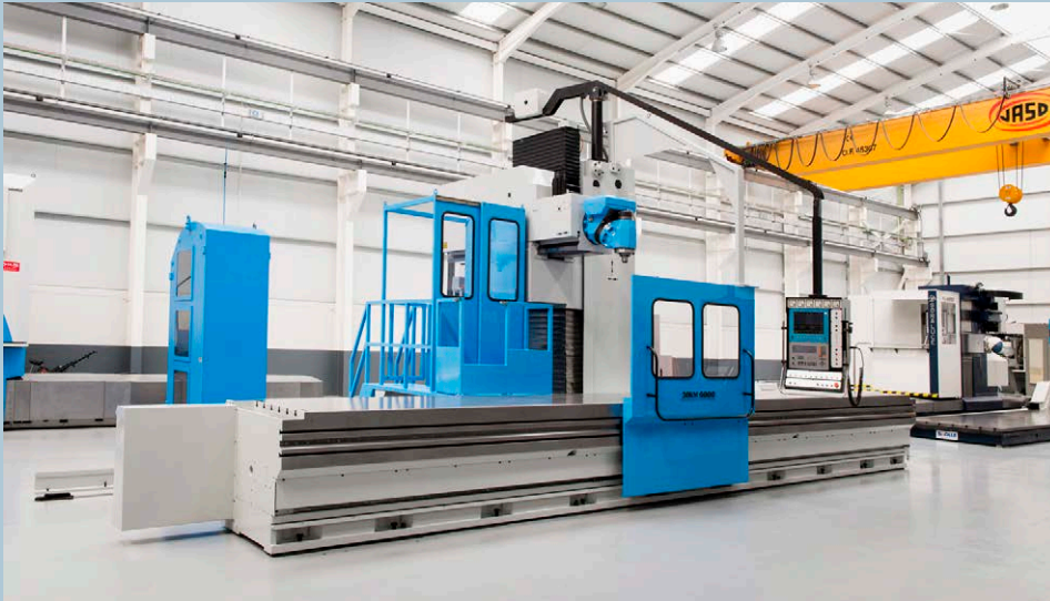
Otro ejemplo de fre-sadora Zayer 30 KMU 9000 reconstruida a la que se modificó el sistema de puestas y la plataforma del operario.
