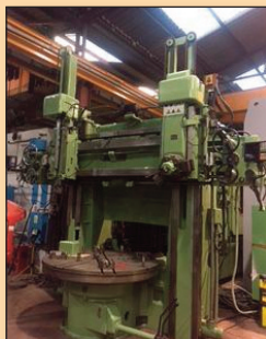
TORNO VERTICAL TOS SK-16, 3 Charriones 1 Lateral y 2 Verticales con Visualizador
