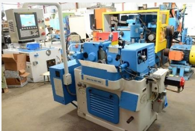
ESTARTA 301 CNC Diámetro máximo a rectificar 50 mm Dimensión de la muela Ø 300x175 mm
