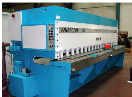
CIZALLA HIDRÁULICA WARCOM 4.000 X 5 mm.
