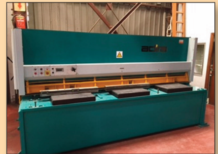
GUILLOTINA ADIRA GHS-1030 3 m x 10 mm Tope Motorizado
