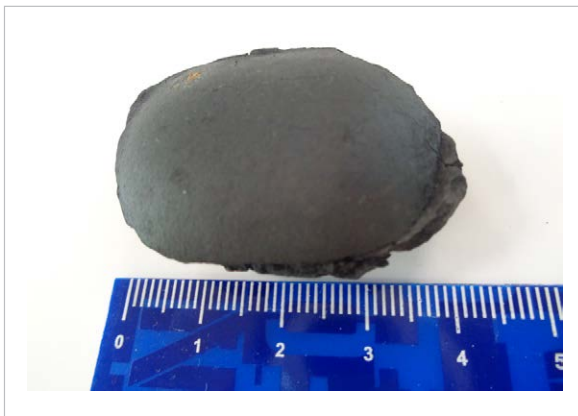
(3) Escorias sinterizadas en formas ovaladas (10-20mm).
