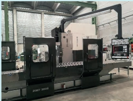
Fresadora ZAYER 20KF-3000 cnc FAGOR 8050M Recorridos: 2710x1024x1004 mm
