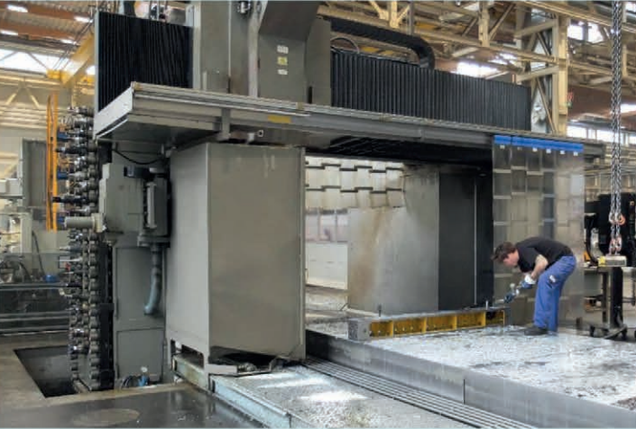
Fresadora ZAYER KPCU6000 ARDT cnc HEIDENHAIN ITNC 530 . (3+2 ejes) Recorridos 6000x3550x1250 mm. Sistema doble mesa. Cargador 100 herramientas.
