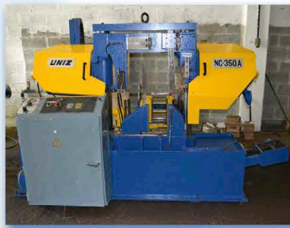
UNIZ NC350A. CNC UNIZ. Cap. Corte: 350 mm
