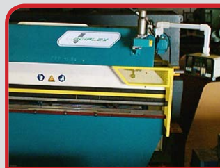
PLEGADORA HIDRÁULICA CNC ACIPLEX, 3 X 65 TN.
