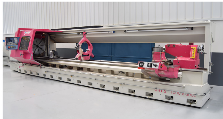
TORNO GEMINIS GHT5 G2 1000x 6000 CNC Fagor 8055. Ø Max.Torneable Sobre Bancada: 1000 mm. Distancia entre centros: 6000 mm.Plato 3 y 4 Garras. Luneta 3 Puntos Protección Plato. Protección trasera completa. Evacuador Viruta. Año 2000
