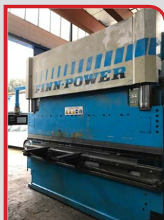
PLEGADORA HIDRÁULICA FINN-POWER, 3 X 120 TN
