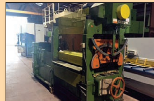
APLANADORA DE CHAPA BONAK 1400x6 mm. Regulación motorizada rodillos Rulinas de apoyo
