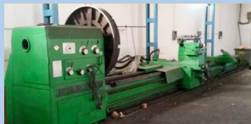
Torno Leopoldo Pontiggia de 8.000 mm entre puntos. Marcado CE.
