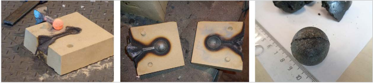
(1a) Escorias esféricas obtenidas por colada y moldeo.
