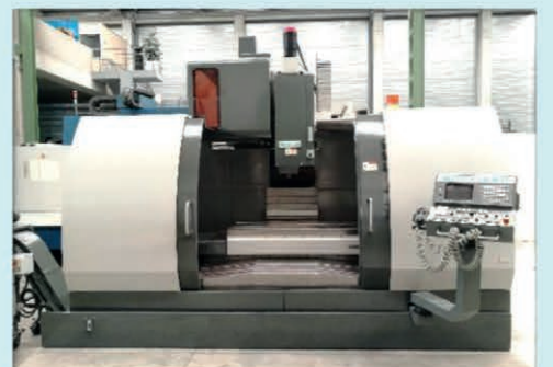
Centro de mecanizado DHALIH MCV 1450 cnc FANUC Recorridos 1450x750x750 mm.
