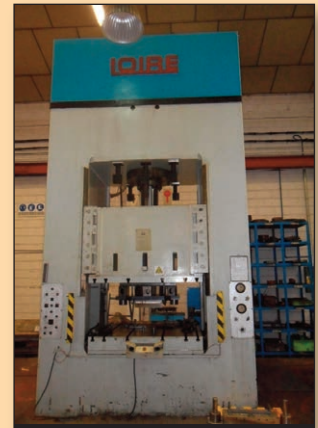
PRESNA HIDRÁULICA LOIRE 200 TM DE EMBUTICIÓN CON COJÍN
