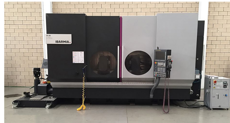
CENTRO MECANIZADO IBARMIA ZV40 L1600 EXTREME CNC FANUC 31i TB. Año 2014. Superficie Mesa: 2.000x650 mm. Recorridos(X/Y/Z): 1.600/600/600 mm. 2 Divisores Gemelos Cargador de 24 Herramientas. Refrigeración Interna.Evacuador Viruta
