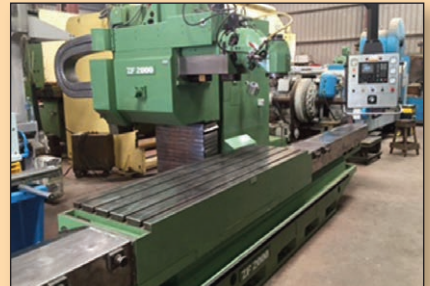
FRESADORA ZAYER ZF-2000 BANCADA FIJA CNC FAGOR 8020
