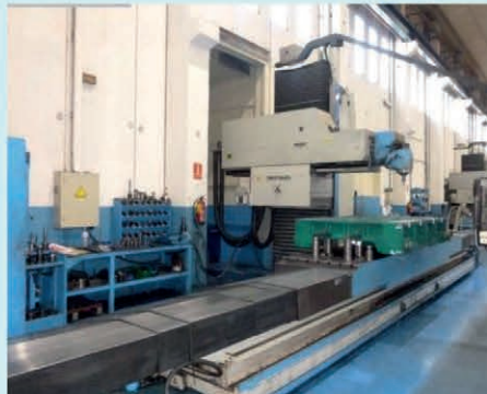
Fresadora ZAYER 30KF-5000 cnc HEIDENHAIN TNC-426 Recorridos: 4710x1508x2013 mm. Cabezal automático.
