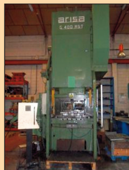
PRENSA EXCÉNTRICA ARISA 400 Tm. CNC con devanadora, aplanador y alimentador
