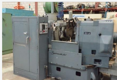
OERLIKON SKM 1 Diámetro máximo a tallar 320 mm Módulo 7,5
