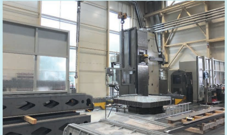
Fresadora ZAYER 30KCU 16000 AR cnc HEIDENHAIN ITNC 530 (3+2 ejes) Recorridos 16000x1500x3500 mm. Cargador 100 herramientas
