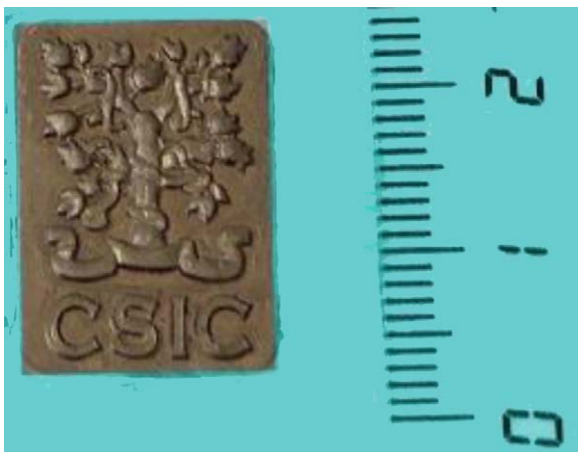
Imagen del logotipo del CSIC fabricado mediante el microfresado en una aleación W78Cu22 utilizando la metodología propuesta. Foto: CSIC.
