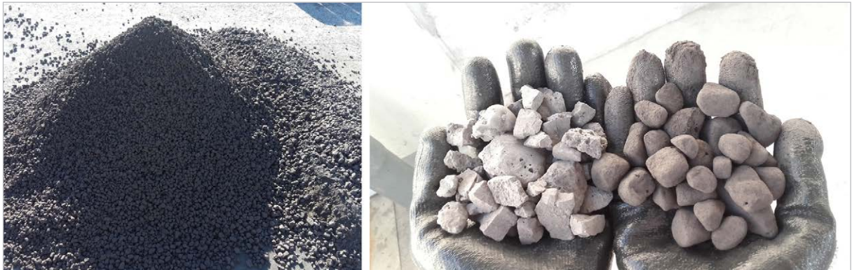
(1b) Escorias de contornos semiesféricos obtenidos por acción mecánica (10-20 mm).
