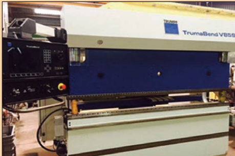
PLEGADORA CNC TRUMPF TRUMABEND V85S CNC DELEM 2.550 mm. x 85 Tm. 5 ejes controlados.
