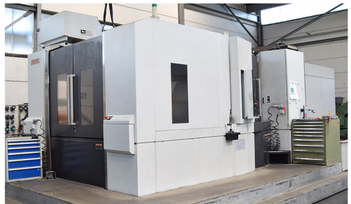
CENTRO MECANIZADO MORI SEIKI NH8000 DCG II MSX-701 / MAPPS III. Recorridos( X/Y/Z); 1.400/1.200/1.350 mm. Mesa Rotatoria con Cambio Pallet: Año 2008. Cono BT50 Cargador de 120 Herramientas. Refrigeración Interna. Sonda Renishaw
