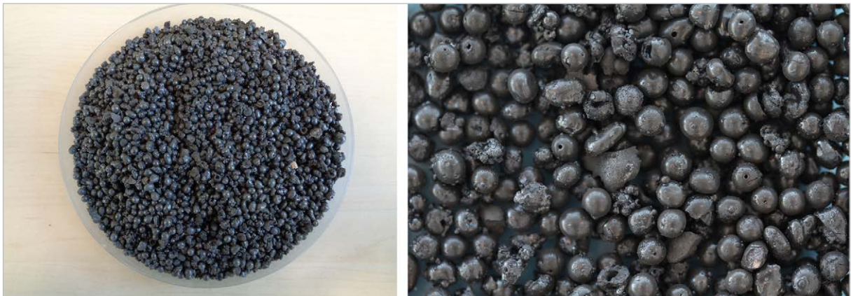
(2) Escorias esféricas obtenidas por atomización (3-4 mm).
