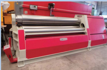
Cilindro de cuatro rodillos AKYAPAK de 3050 x 16-20. Marcado CE.
