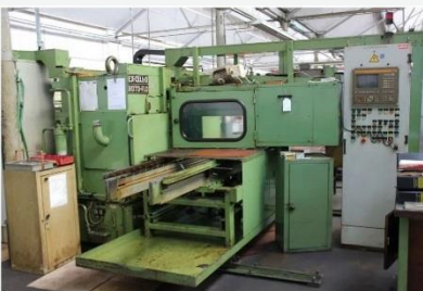
EX-CELL-O XK225 ROTOFFLO Diámetro máximo a laminar 41mm Módulo 1,5 / 0.39
