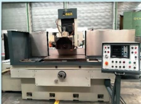
Rectificadora tangencial GER S-100/50 CN FAGOR Dimensiones 1000x600 mm.
