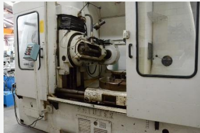
PFAUTER P 1250 Diámetro máximo a tallar 1250 mm Módulo 12
