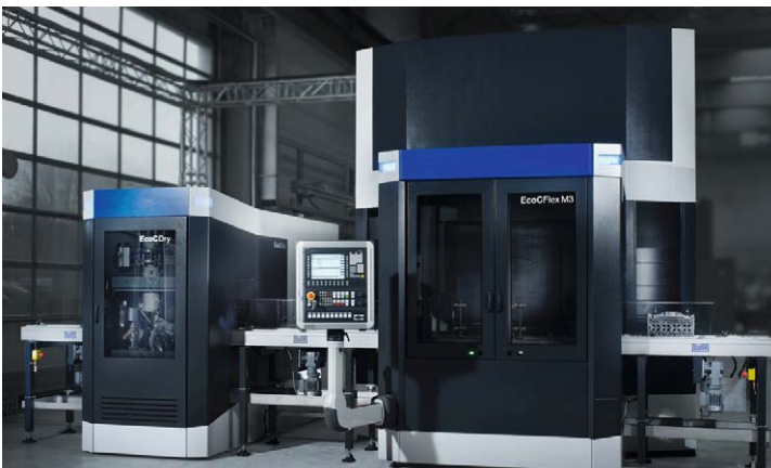
La innovadora tecnología de control de procesos de EcoCwave permite la limpieza eficiente de grandes cantidades de piezas. Los depósitos de inundación dispuestos de forma vertical y con un diseño que optimiza el flujo contribuyen a la alta calidad de limpieza y a una larga vida útil del baño.
