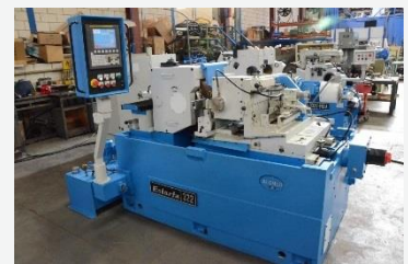
ESTARTA 322 CNC Diámetro máximo a rectificar 120 mm Dimensión de la muela Ø 508x254 mm
