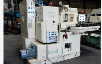
HURTH WF-10 Diámetro máximo a tallar 320 mm Módulo 6
