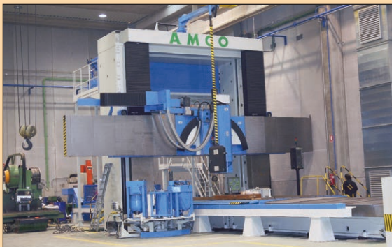
FRESADORA PUEBTE AMCO-SACEM PPF-4500, 5 Ejes controlados, CNC Heidenhain 530i X: 10.000 mm. Y: 5.900 mm. Z: 1.200 mm. W: 3.000 mm. Cambio automático de cabezal
