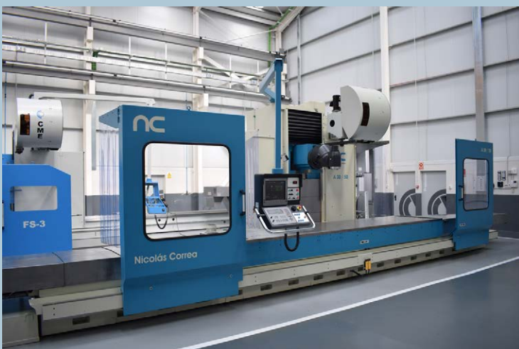
En esta imagen puede verse una fresadora Correa A30/50 reconstruida a la que se le instaló un cargador de herramientas.
