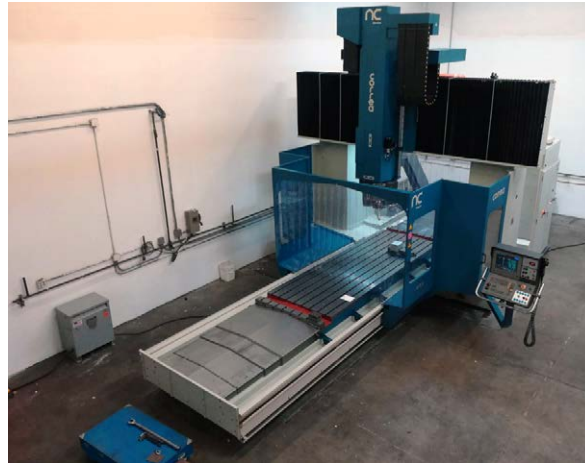
Fresadora Correa FP40/40 tras su reconstrucción e instalación en el cliente por NC Service.
