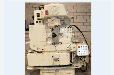
HURTH ZSA 550/220 Diámetro máximo a afeitar 550 mm Módulo 8
