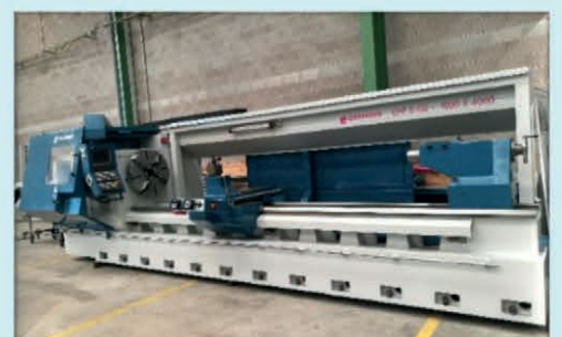
Torno CNC GEMINIS GHT5 G2 1000x4000 cnc SIEMENS E.P. 4000 x Ø 1000 mm. Con extractor virutas
