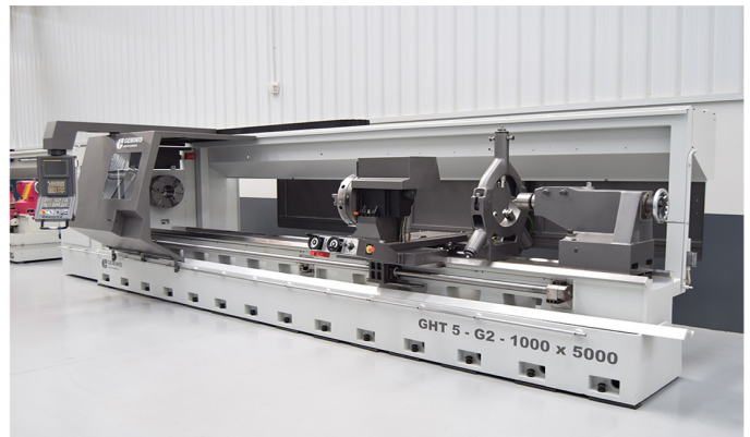
TORNO GEMINIS GHT5 G2 1000x 5000 CNC Fagor 21i TB. ØMax. Sobre Bancada: 1000 mm. Distancia entre centros: 5000 mm Eje C y Herramientas Motorizadas. Torreta 8 Posiciones. Evacuador Viruta. Año 2006. Reconstruido
