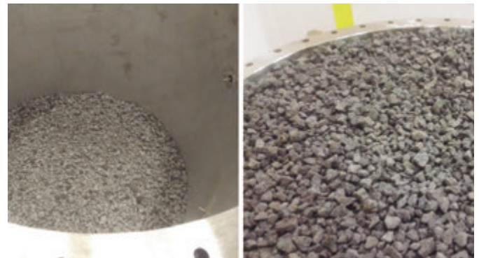
FOTO 2: Unidad de testeo en la cual se puede ver la configuración del material de almacenamiento térmico (escoria negra tratada) durante su instalación y montaje.
