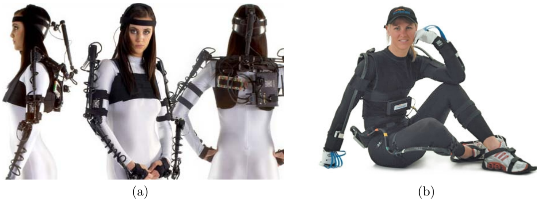
Figura 3.14: Sistemas mecánicos. (a) Sistema Gypsy6 de Animazoo , de varillas rígidas. (b) Sistema ShapeWrap III de Measurand , de varillas flexibles.
