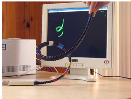
Figura 3.7: Sistema mecánico flexible de fibra óptica desarrollado por Measurand .
