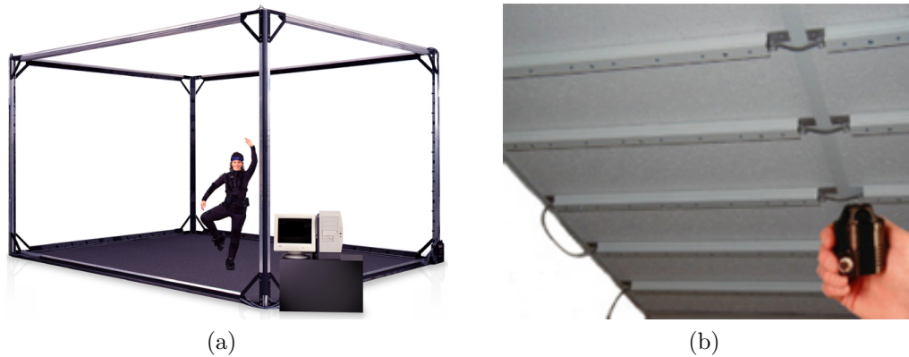
Figura 3.11: Sistemas ópticos de Ascension y 3rdTech . (a) Estructura ReActor2 de Ascension . (b) Sistema óptico de dentro hacia fuera HiBall-3100 de 3rdTech ; la mano se muestra sujetando el sensor, mientras que las balizas se encuentran detrás de ella.
