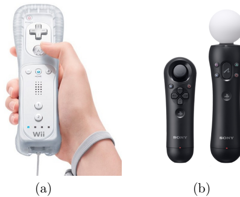
Figura 3.16: Sistemas inerciales. (a) Controlador Wii Remote de la consola Wii de Nintendo , un sistema híbrido inercial-óptico. (b) Controlador PlayStation Move de la consola PlayStation 3 de Sony , un sistema híbrido inercial-óptico-magnético.
