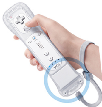
Figura 4.6: La extensión Wii MotionPlus acoplada en un Wii Remote .
