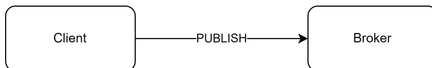
Abbildung 3.6: Übertragung einer Nachricht mit QoS 0 (Quelle: eigene Darstellung nach [24])
