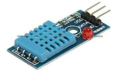
Fig 2. DHT11 TEPERATURE & HUMIDITY SENSOR
