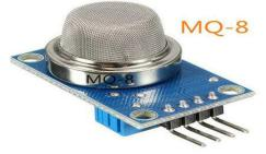
Fig 3. MQ-8 HYDROGEN GAS SENSOR
