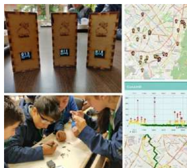
FIGURA 1 - Projeto CanAirIO: dispositivos de sensoriamento da qualidade do ar com componentes de baixo custo. Fonte: https://canair.io/docs/
