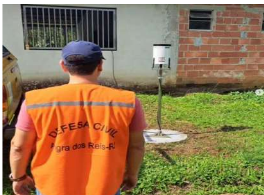
FIGURA 4 - A Defesa Civil de Angra instalou um pluviômetro semiautomático na comunidade quilombola do Bracuí, com este equipamento os moradores poderão auxiliar sua Defesa Civil no monitoramento do volume de chuva em sua localidade e ficarão informados se existe ou não risco de transbordamento de rios e deslizamentos de encosta. Acervo dos autores.
