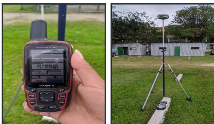
FIGURA 2 - Equipamentos utilizados na obtenção das coordenadas: receptor GNSS Trimble R6 model 4, de duas frequências (L1/L2) (esq.) e receptor GPS de navegação Garmin 62stc (dir.). Elaboração própria.
