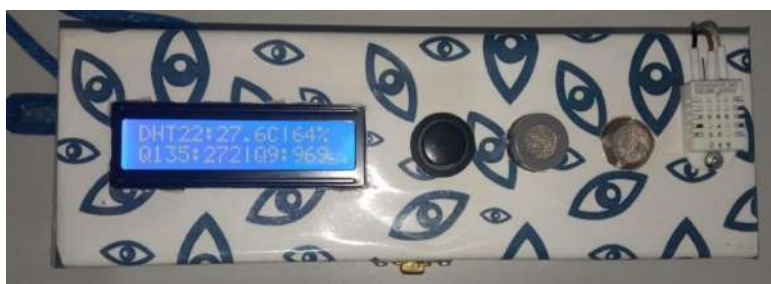
FIGURA 2 - Protótipo Qualiar para monitoramento ambiental de baixo custo, construído a partir de componentes de baixo custo. Elaboração própria.
