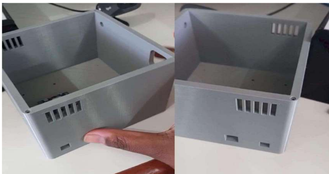
FIGURA 5 - Caixas do sensor impressa em PLA na impressora 3D Creality. Fonte: Maria Santos.
