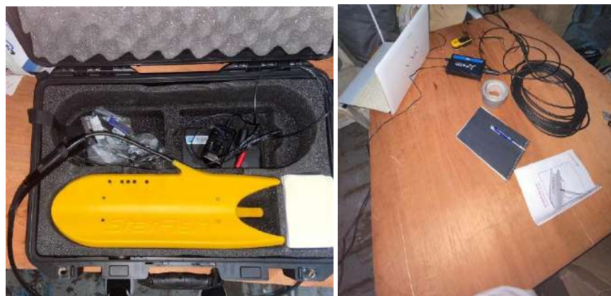
FIGURA 2 - A) Side Scan Sonar, Starfish 452F Pro (esq.) B) mesa montada para recepção dos dados (dir.). Acervo dos autores.
