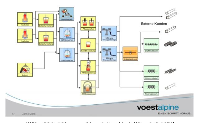
Abbildung 5-3: Produktionsprozess-Schema der Voestalpine Stahl Donawitz GmbH [48]
