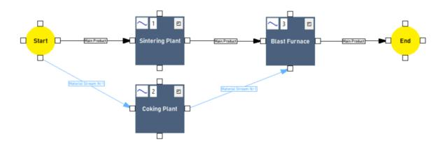
Abbildung 4-4: Beispiel 2 - Prozessschema mit Haupt- und Nebenstrom
