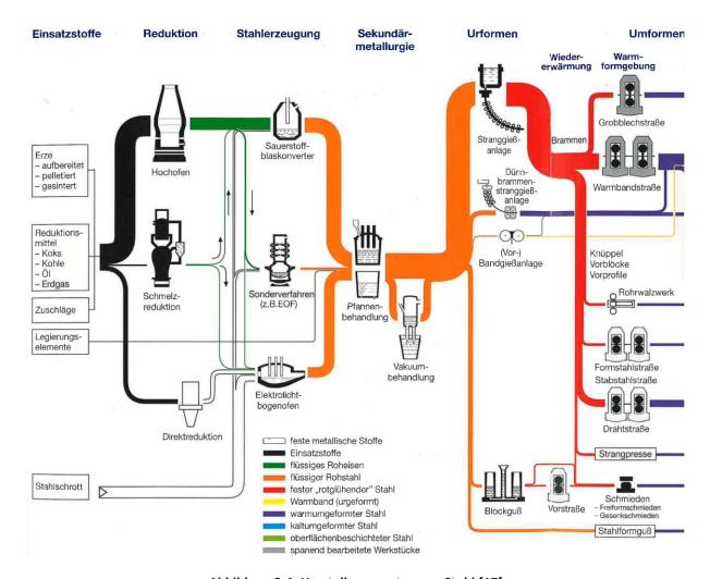
Abbildung 3-4: Herstellungsrouten von Stahl [17]
