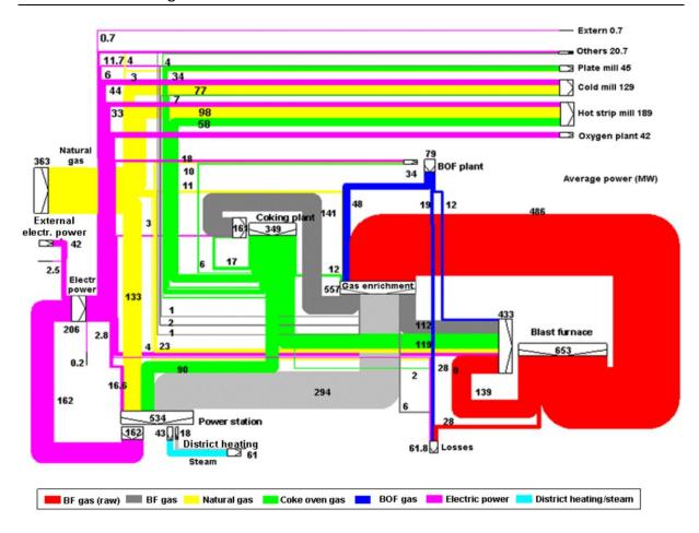
Abbildung 3-7: Beispiel – Energieströme in einem integrierten Hüttenwerk [21]
