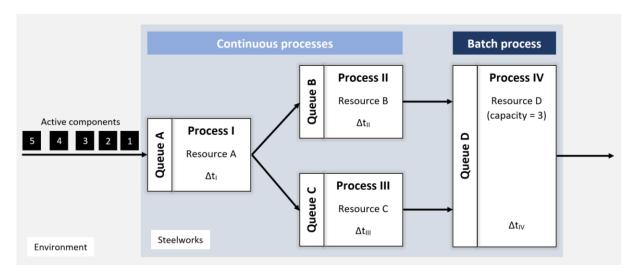
Abbildung 4-7: Prozessstruktur mit Conti- und Batchprozessen
