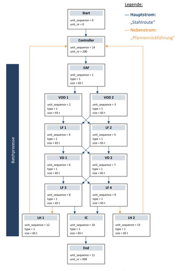
Abbildung 5-12: Prozesskette der Elektrolichtbogenofenroute
