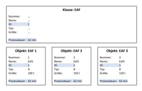
Abbildung 4-2: Beispiel zur objektorientierten Programmierung
