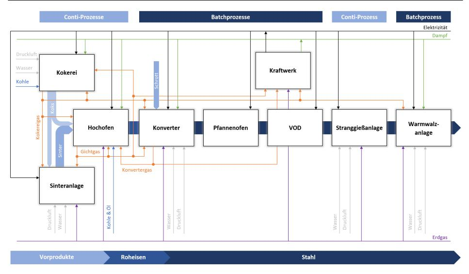
Abbildung 3-9: Prozessrelevante Energie- und Massenströme der Hochofenroute
