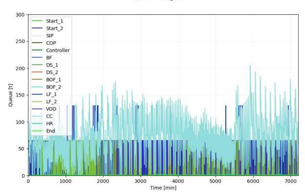
Abbildung 5-8: "Queue"-Verläufe aller Objekte der Hochofenroute
