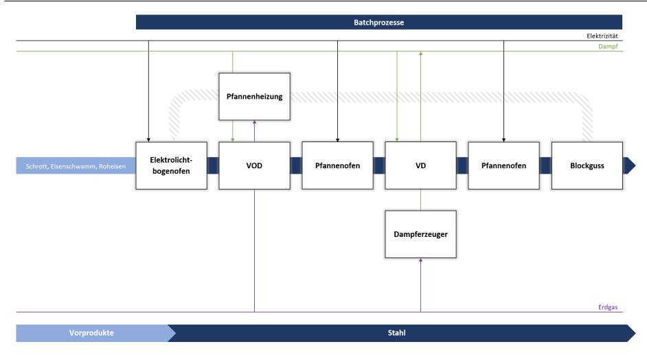
Abbildung 3-10: Prozessrelevante Energie- und Massenströme der EAF-Route
