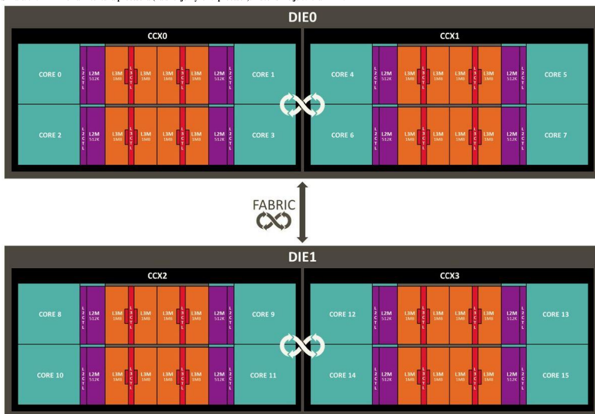
Slika 69.A. AMD Zen arhitektura procesora (na slici je Ryzen 9 procesor). Autor slike je tvrtka AMD.
