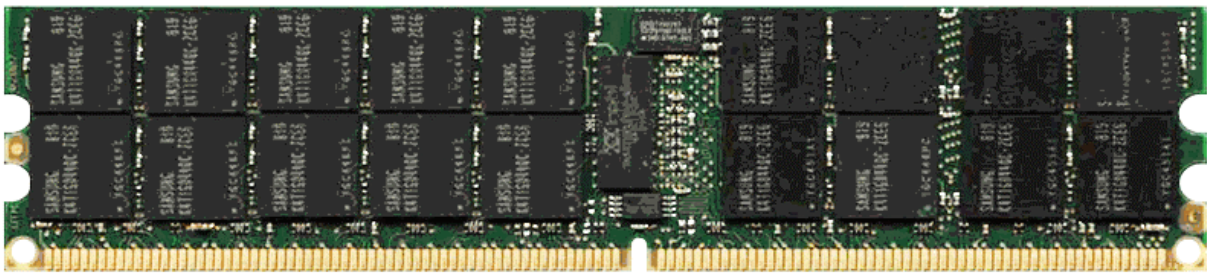
Slika 91. 4GB 240 pinske DDR2-3200 ECC Registered memorije.
