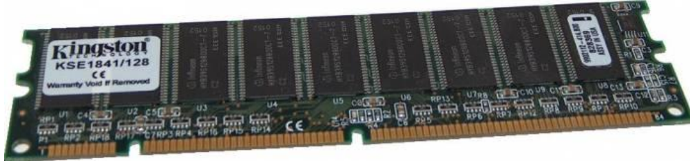
Slika 90. Izgled SDR SDRAM PC-100 ECC memorije.
