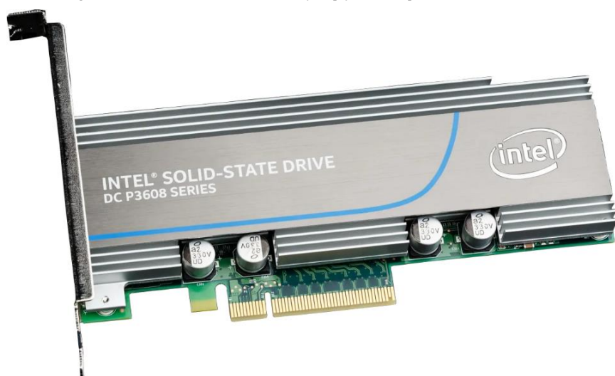
Slika 112.1. Pogled na NVMe disk tvrtke Intel (DC P3608), koji se spaja na PCI Express sabirnicu (x8).
