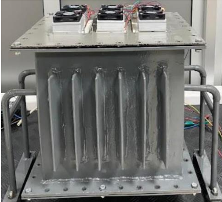
Şekil 5: Peltier modül ile yağ tipi transformatör soğutucu(TOREN & MOLLAHASANOGLU, 2022)
