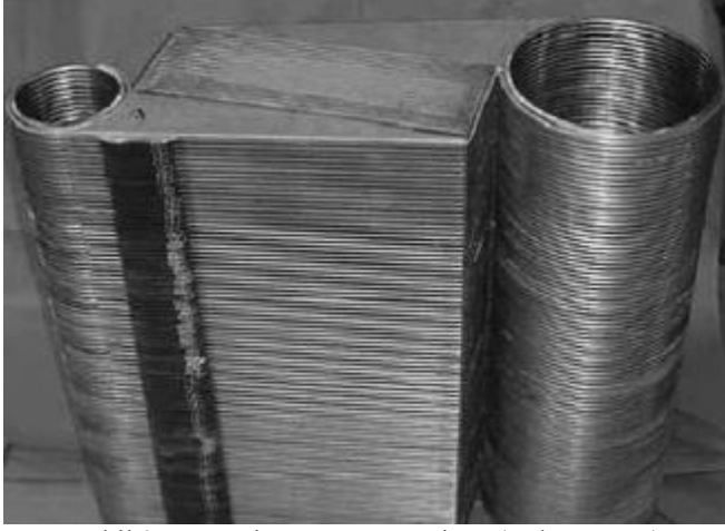
Şekil 3: Isı Geri Kazanım Eşanjörü (Reküpreatör)
