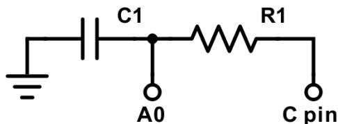
Slika 1, Sa *C pin* je označen pin preko koga se puni kondenzator (eng. *charge pin*), *C1* je nepoznata kapacitivnost, *A0* analogni ulaz, *R1* je otpornik u RC kolu (ovde  $10\text{ k}\Omega$  ili neka druga odgovarajuća otpornost). Šema je složena u programu Scheme-it (Digikey Electronics, USA).
