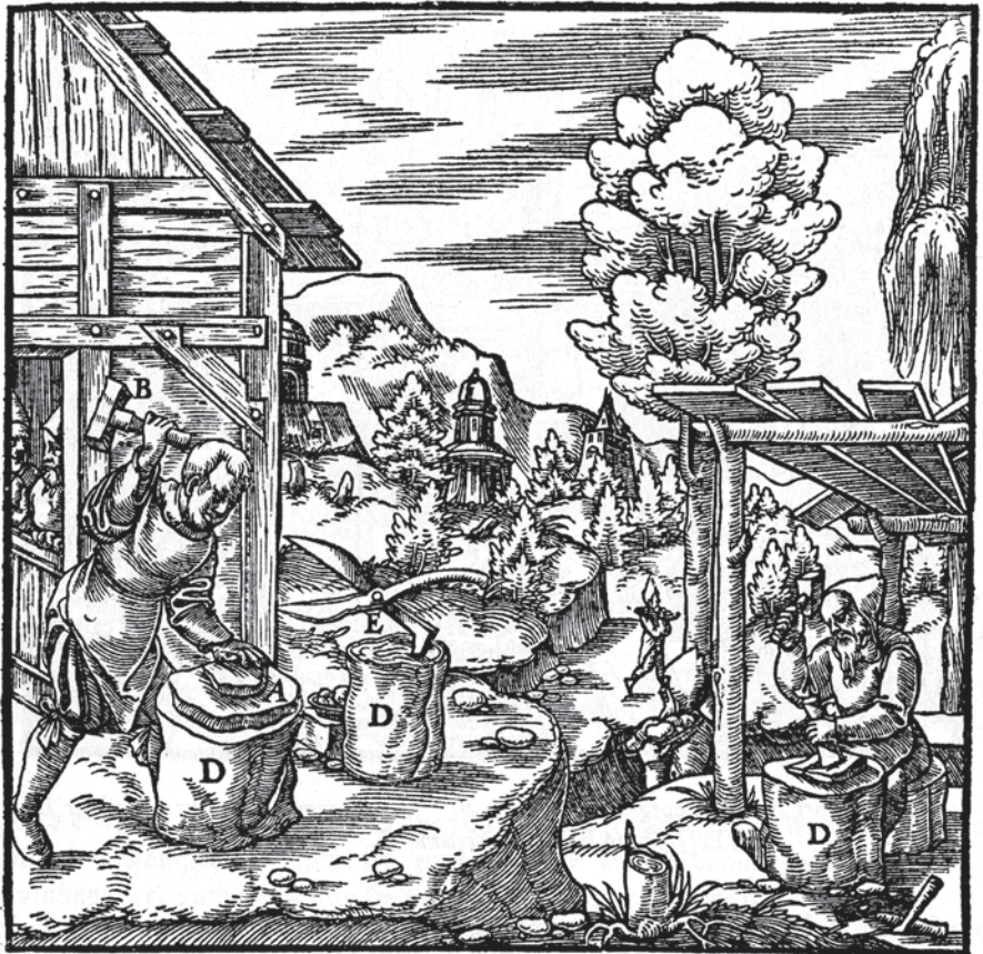
Eine Stufe Erz A. Der Quetscher B. Der eiserne Meißel C. Der Stock D. Die Schere E.
