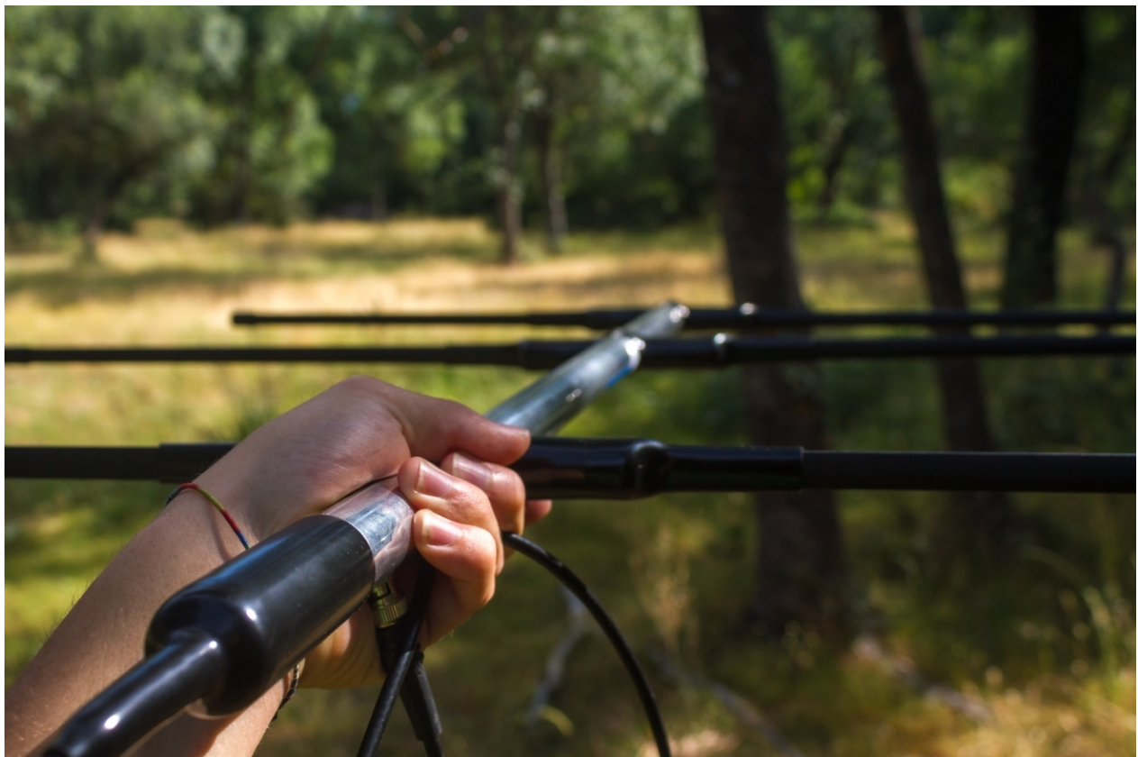
Figura 1. Antena Yagi portabilă pentru recepție semnal VHF (© Shutterstock).
