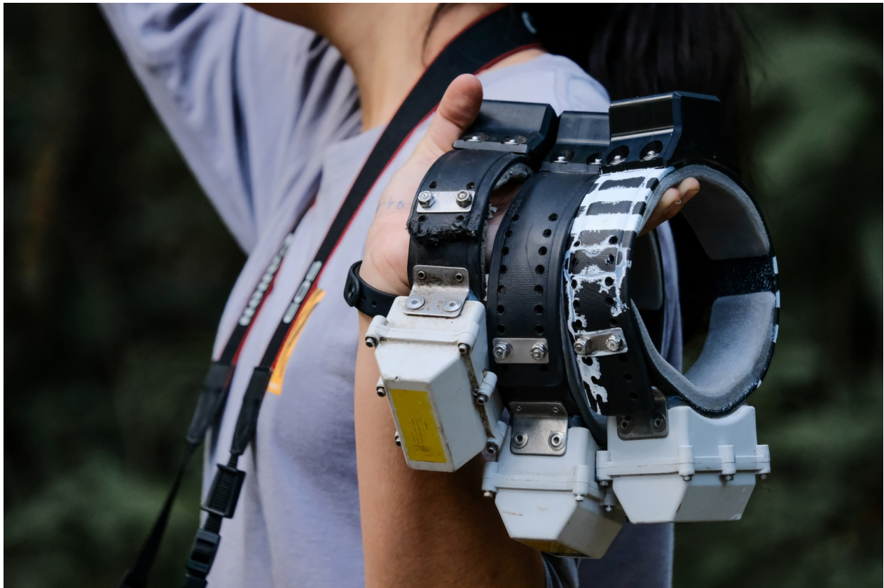
Figura 12. Dispozitive de localizare tip GPS colier cu sistem drop-off (© Shutterstock).
