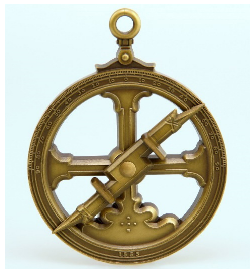
Figura 90 – Astrolábio: instrumento náutico antigo, usado para medir a altura dos astros
