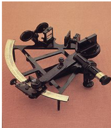
Figura 91 – Sextante: usado para medir a distância angular na vertical entre um astro e a linha horizontal
