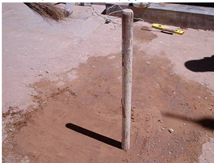
Figura 93 – Gnômon: parte do relógio solar, usado para indicar a hora com a projeção da sombra
